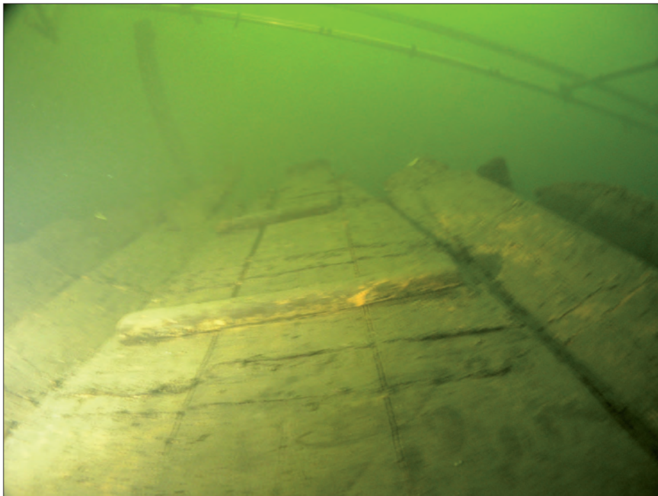
Fig. 32. Fartygslämningens skrov sett från aktern mot fören. Den platta botten utgörs av tre plankor varav den mittersta är något grövre än de andra. Vid slaget, till höger och vänster i bild, övergår bordläggningen till klink. De spikade spanten på bilden är raka – våghål förekom på de spant som var placerade mellan botten och slaget. Foto: Jens Lindström/Statens maritima museer.
