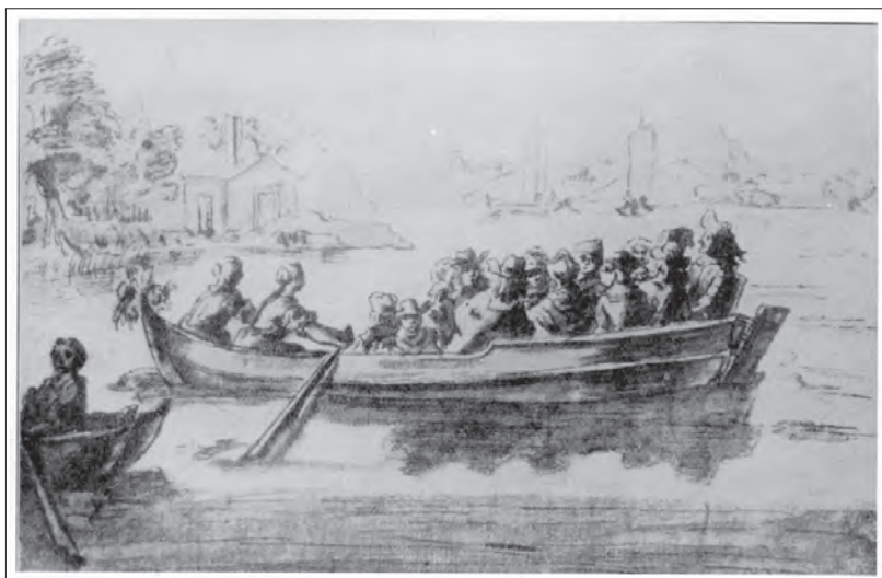
Fig. 34. Öppen båt i Mälaren för persontransporter. Båten är något större än fartygslämningen vid Söder Mälarstrand och är i motsats till detta försedd med ett roder i aktern. Avbildning av Lorenzo Magalotti 1674 (Stenbock 1912: plansch 10).
