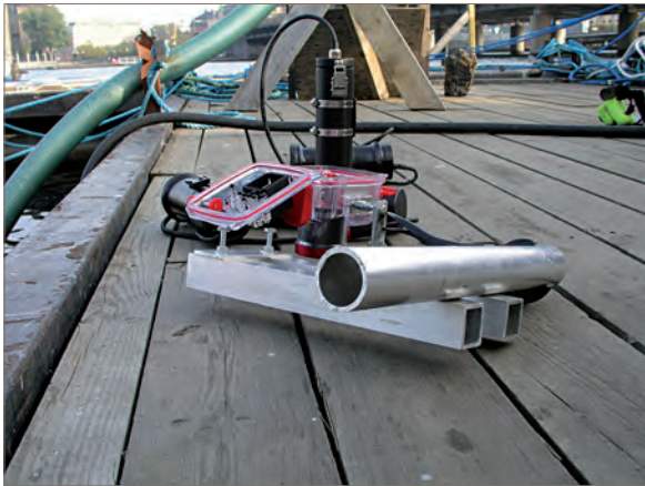
Fig. 94. Med hjälp av bland annat rör i aluminium konstruerades en släde till stillbildskameran som flyttades successivt över undersökningsområdet vid arbetet med fotomosaiken. Foto: Jens Lindström/Statens maritima museer.
