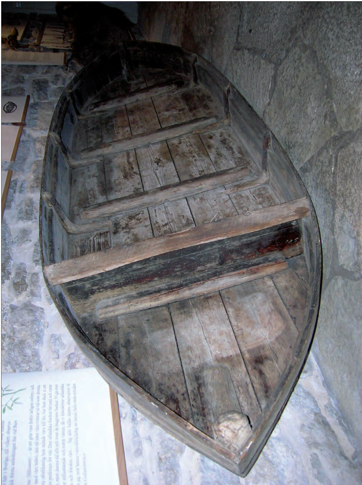
Fig. 37. Fartyget i Fornsalen är av intresse i sammanhanget då det är spantat på i princip samma sätt som fartygslämningen i Riddarfjärden. Foto: Patrik Höglund /Statens maritima museer.
