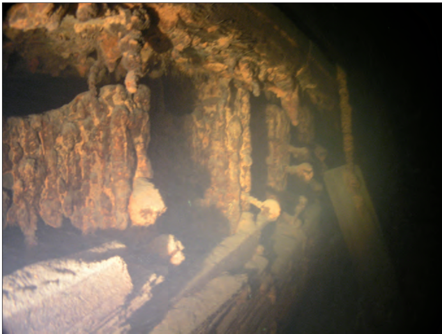
Fig. 42. Detalj av den sjunkna pråmen från 1944. På bilden syns järnspant och bordläggning i trä på babords sida. Djup 19 meter. Foto: Jens Lindström/Statens maritima museer.
