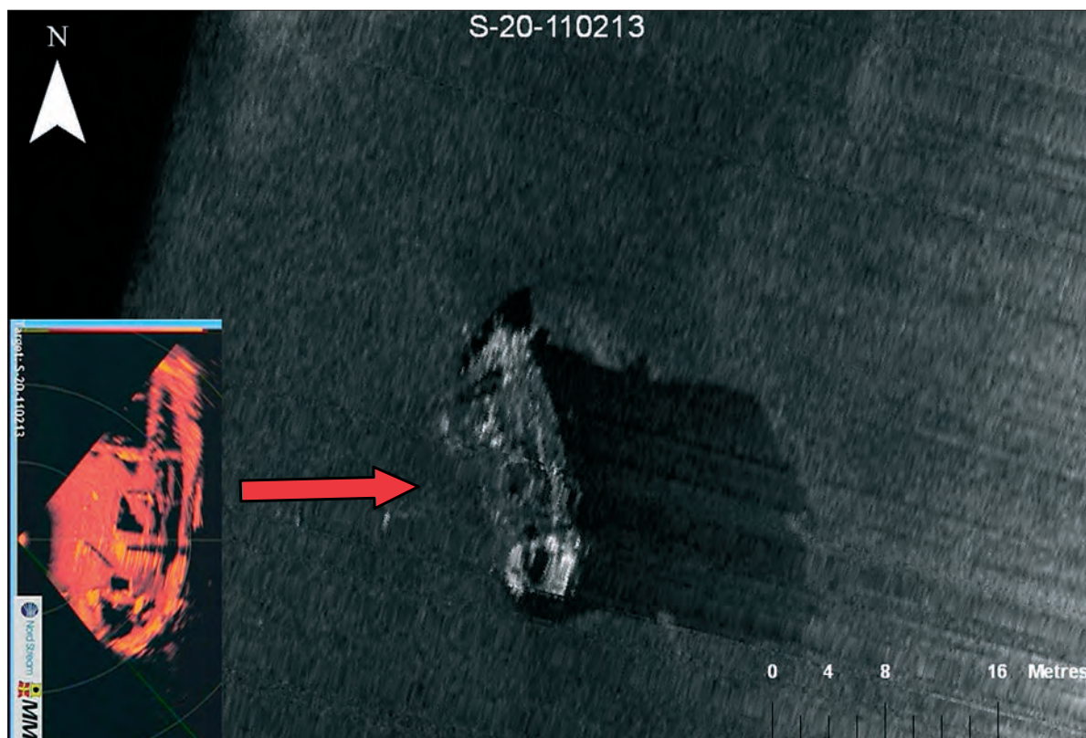
Fig. 18. SSS-bild på S-20-110213 samt en SSS-bild tagen med ROV västerifrån. Det syns tydligt på den inklippta ROV-sonar-bilden att styrbordssidan är nedsjunken i bottensedimentet (MMT).
