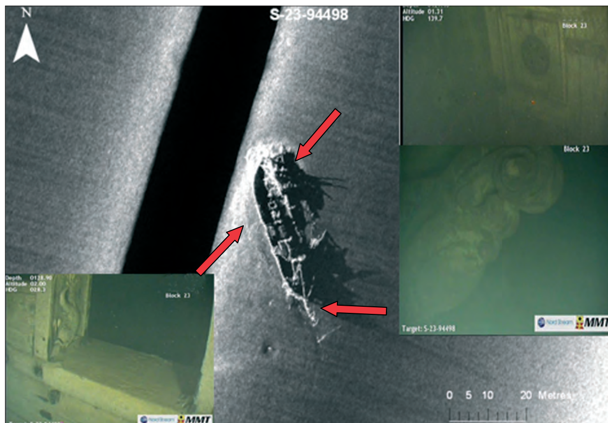
Fig. 35. SSS-bild och ROV-bilder på hytt dörr med ventilator, galjonen med volut och sköld samt fallrepsporten med de snidade valarna/delfinerna (MMT).
