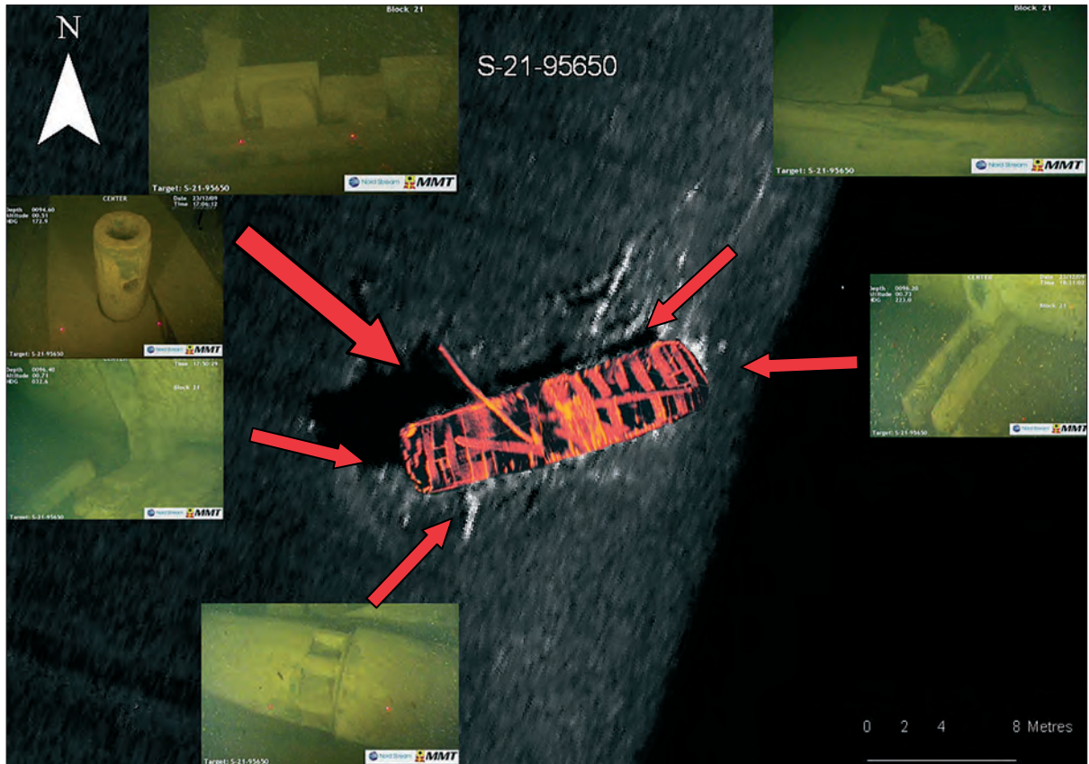
Fig. 31. SSS-bild på S-21-95650 med två SSS-bilder från ROV inklippta. Bilder motsols från höger: akterstäv, möjlig avbruten mast, spant, alpump, förstäv och bråspel. Bilder: MMT. Montage: Mikael Fredholm, Sjöhistoriska museet.
