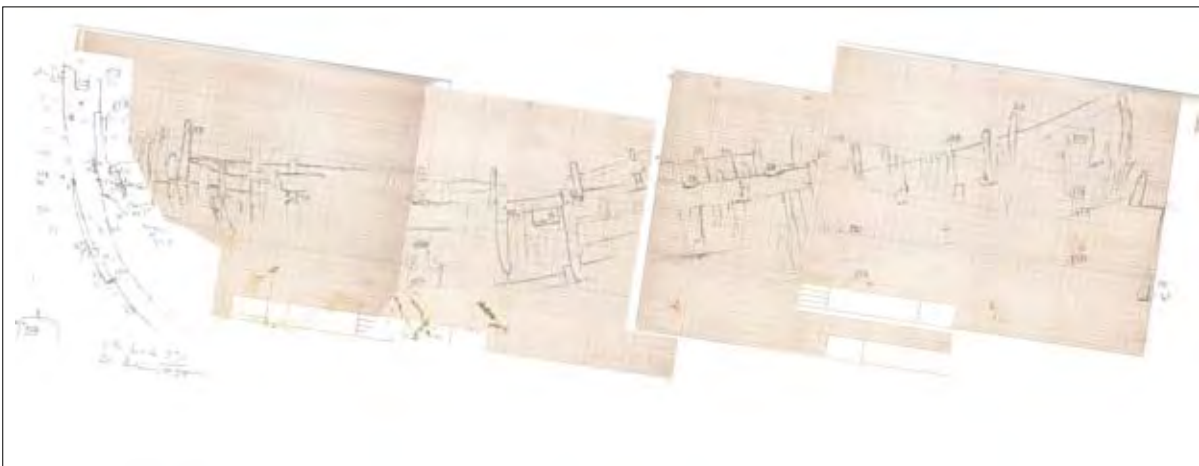
Fig. 5. De inmätta fixpunkterna prickades ut på mm-rutat papper i skala 1:20. Med stöd av dessa fixpunkter skissades den sammanhängande skrovstrukturen. Figuren ovan är en mosaik av undervattensskisser. Mosaiken motsvarar den vy som avbildas i fig. 4 (DSM-figuren). Ritning: Niklas Eriksson, Sjöhistoriska museet.
