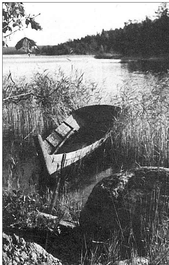
Fig. 12. Ovanlig stävkonstruktion på båt som påminner om objekt 48. Stäven är urholkad och liknar Björkebåtens stäv, daterad till 100 e.Kr. Foto Nordiska museet.
