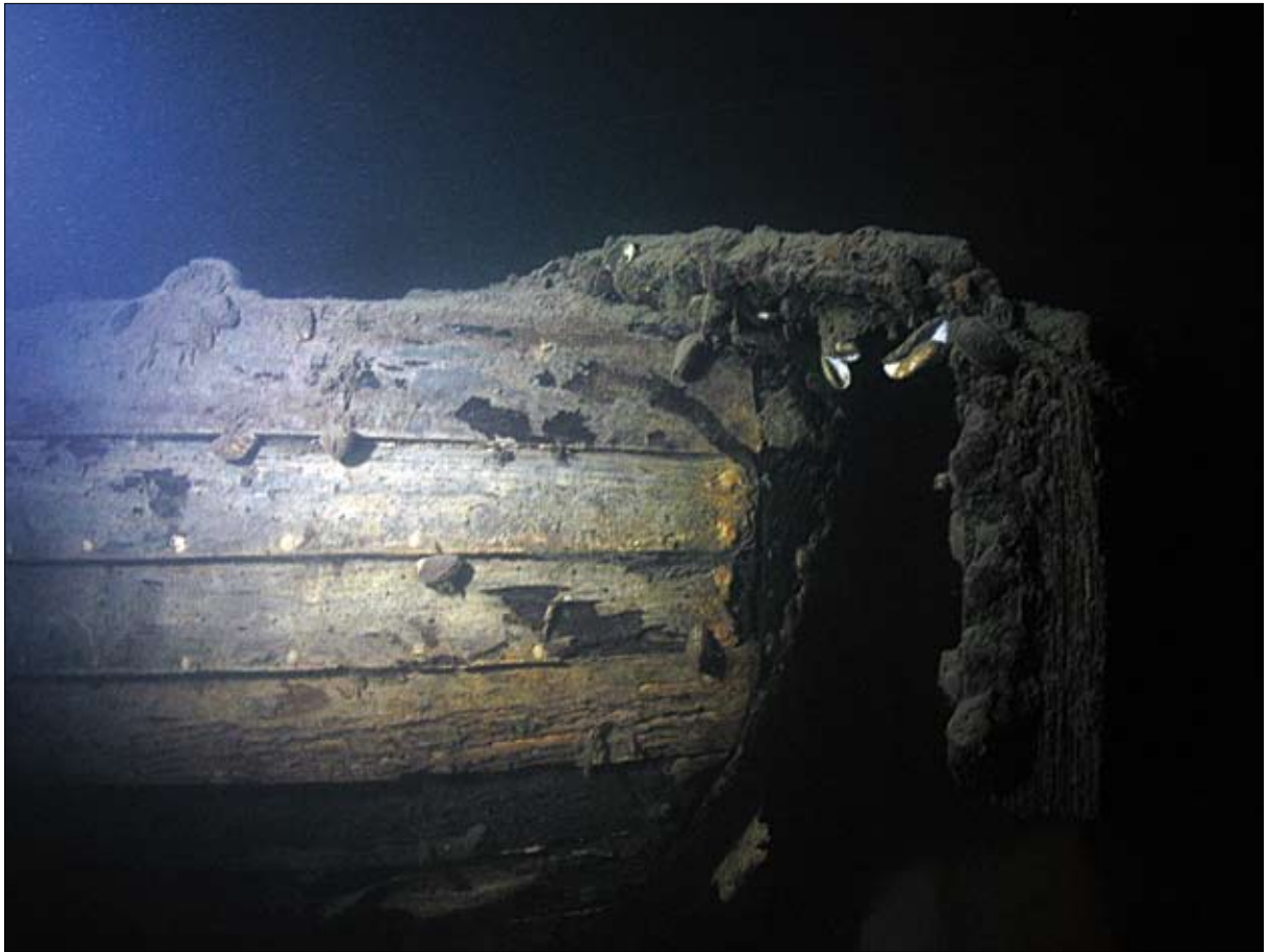
Fig. 20. Objekt 9 – klinkbyggd segelbåt. Förstäv med trasigt bogspröt. Foto: Jens Lindström, Sjöhistoriska museet.
