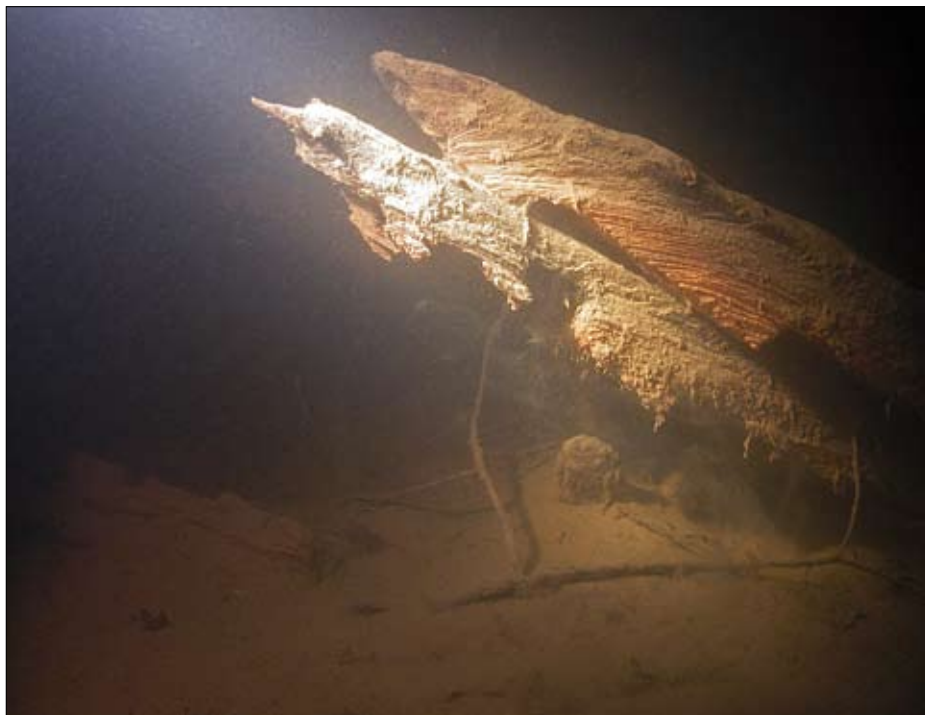
Fig. 23. Objekt 13 – klink- byggd "större skuta", sannolikt en Mälarjakt. Spant med klinkhak. Foto: Jim Hansson, Sjö- historiska museet.
