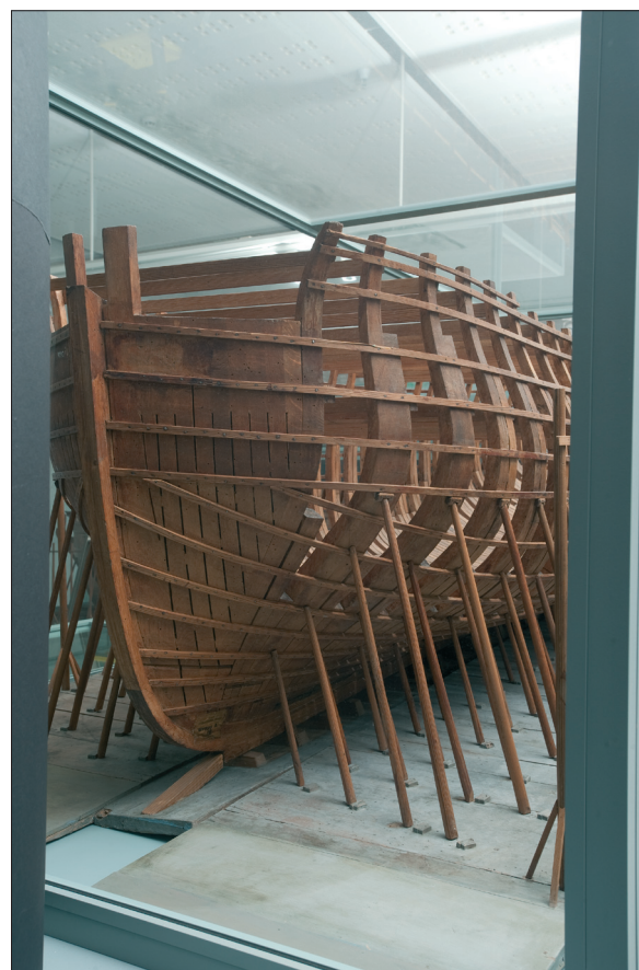
Fig. 3. Spantmodell av linjeskepp i Kronprins Gustav Adolfserien. De s.k. kantringsspanten återfinns mellan förstäven och de egentliga spanten. Foto: Erling Klintefors, Marinemuseum.
