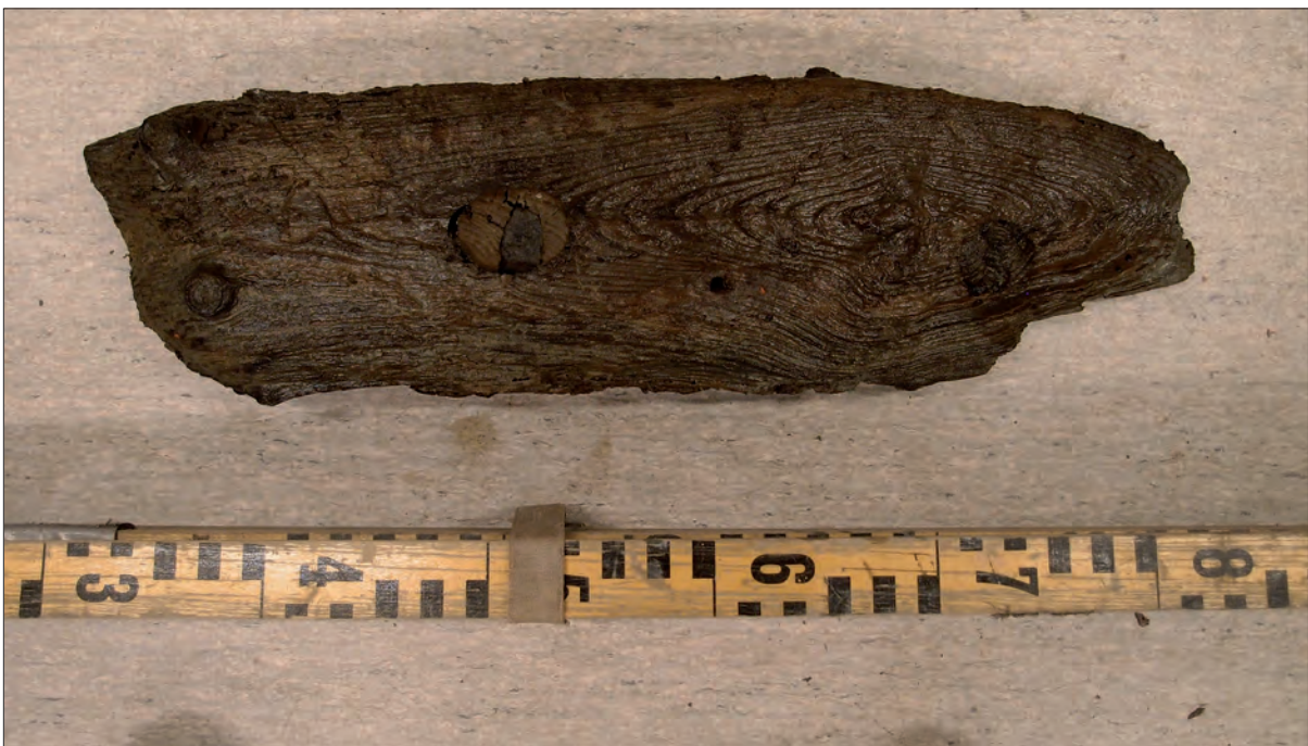
Fig. 8. Del av spant från Västerviken II. 56 cm lång, 16 cm bred och 7 cm tjock. En trädymling med kil, 3,2 cm diameter. Foto: Trevor Draeseke, Sjöhistoriska museet.
