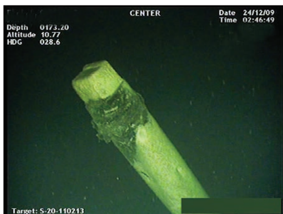
Fig. 9. Toppen av mast, 2009 respektive 2012. Små slitskador i toppen och på sidorna (högra bilden 2012) som de två pilarna pekar på. Foto: MMT, FUGRO och Nord Stream.
