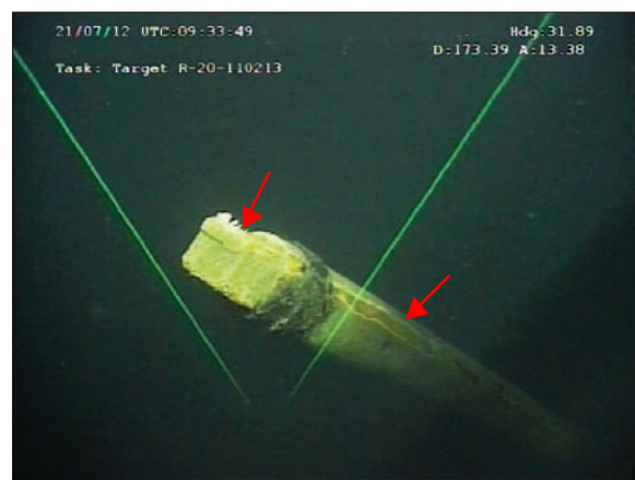
Fig. 9. Toppen av mast, 2009 respektive 2012. Små slitskador i toppen och på sidorna (högra bilden 2012) som de två pilarna pekar på. Foto: MMT, FUGRO och Nord Stream.
