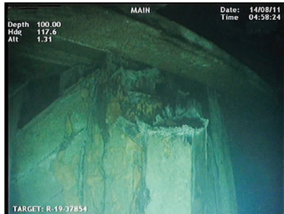
Fig. 2. Roder och akter före och efter ankarkabelns skadegörelse. Foto: MMT, FUGRO och Nord Stream.
