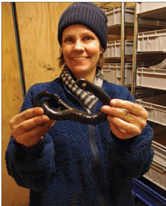
Figur 34. Kroken är välbevarad och man kan se kauset samt det lilla hålet för låsning. Foto: Jim Hansson, Sjöhistoriska museet.
