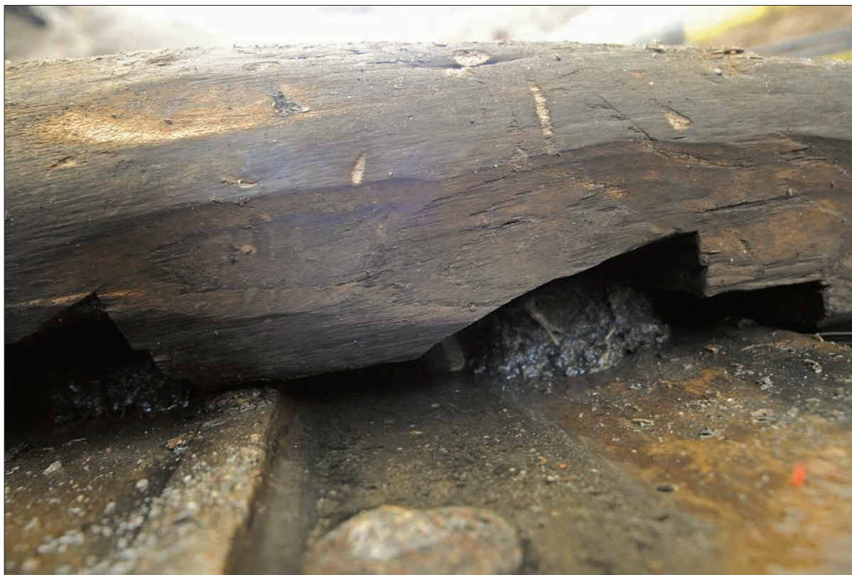
Figur 45. Bilden visar två felhuggna klinkhak. Inget tydde på att detta var ett återanvänt spant. Misstagen är troligen resultatet av en allt för snabb byggnation. Foto: Jim Hansson, Sjöhistoriska museet.
