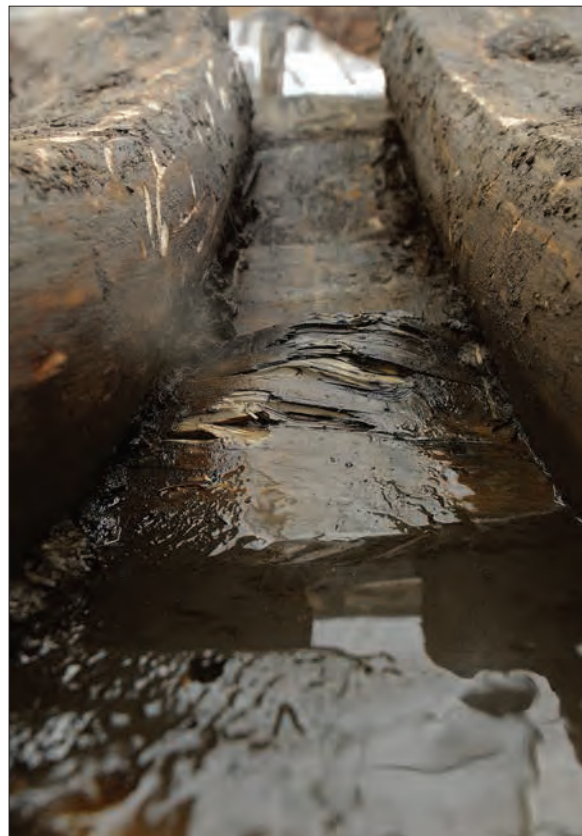
Figur 55. Bilden visar bordläggningen som knäckts. Avståndet mellan bottenstockarna samt att knäcken är i skarven mellan borden gör att kollisionen måste ha varit mycket kraftig. Foto: Jim Hansson, Sjöhistoriska museet.
