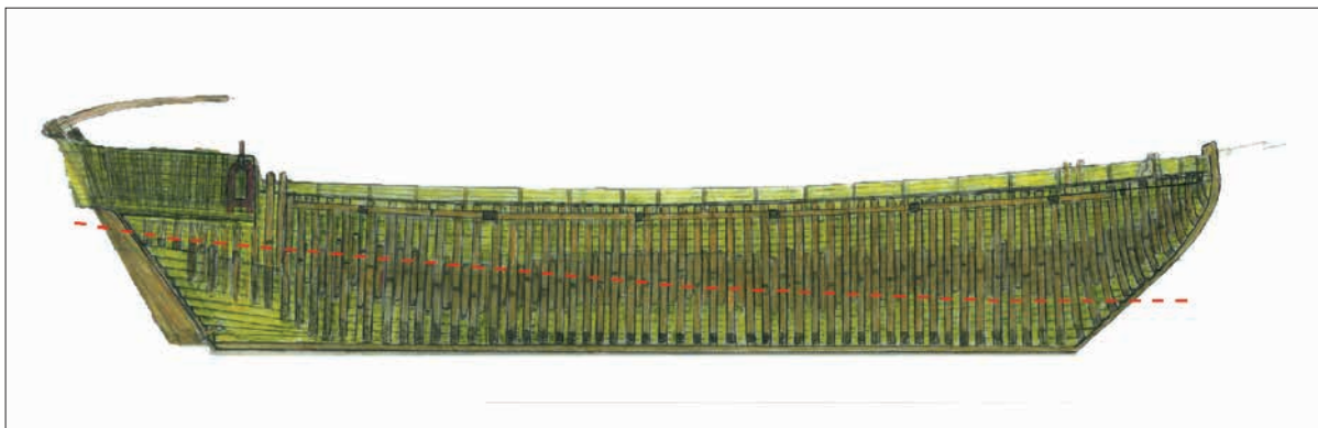
Fig. 9. Rekonstruktionsritning av det s.k. Engmanvraket. Den röda streckade linjen visar ungefär till vilken nivå vraket i Norra hamn är bevarat. Lägg märke till förstärkningsspanten i höjd med den streckade linjen. Ritning: Harry Alopeus/Länsmuseet Gävleborg
