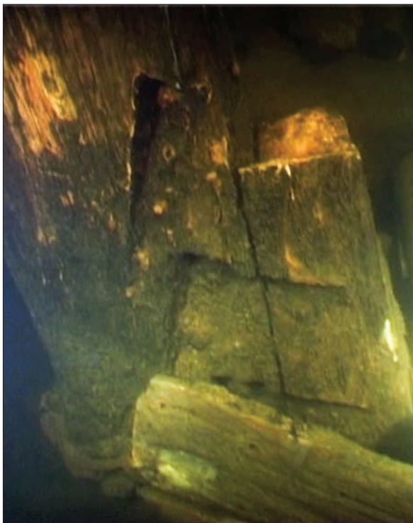
Fig. 4. T.h. insidan av akterstäven med urtaget för infästningen av akterspegeln. Foto: Eduardo Roa Brynhildsen/Sjöhistoriska museet. T.v. styrbordsidan av akterstäven med urfästningarna för infästning av bordläggningens plankorna. Foto: Jens Lindström/Sjöhistoriska museet.
