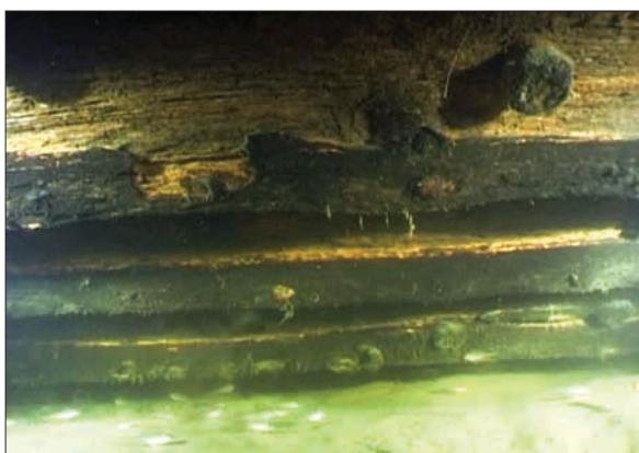
Fig. 7. På utsidan av styrbordsidan syns det tydligt att bordläggningen är lagd på klink. Längst upp till höger i bild syns en utstickande trädymling. Notera de mörkare partierna i underkant av borden. Foto: Jens Lindström/Sjöhistoriska.
