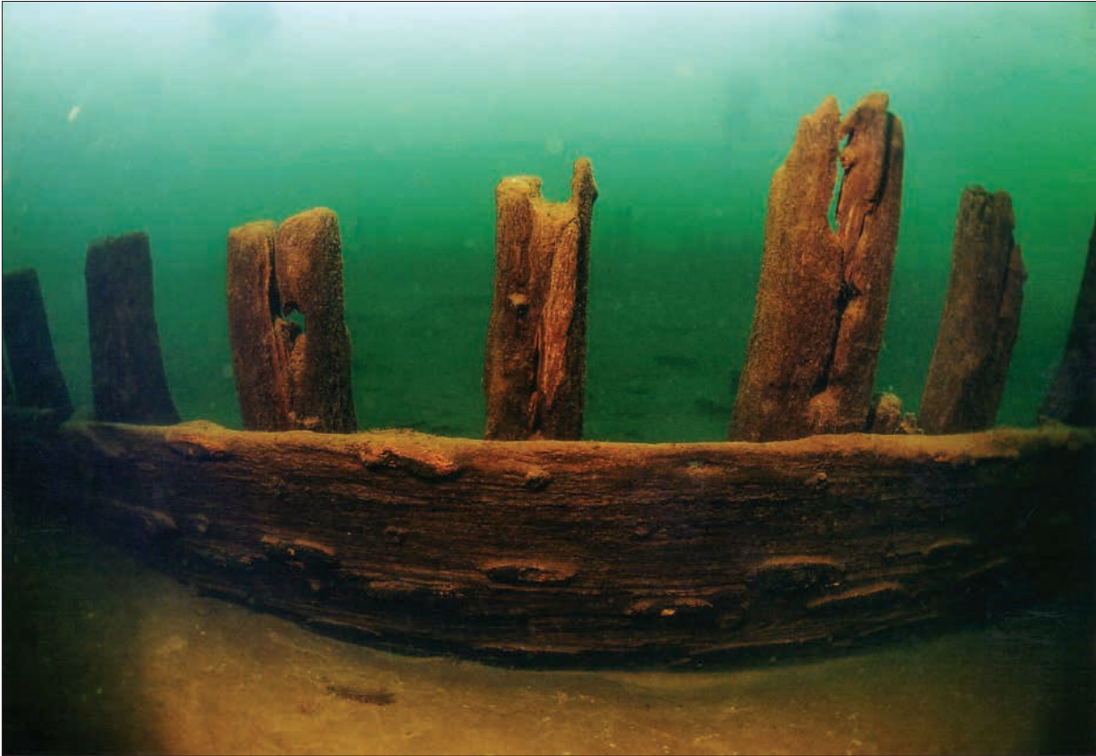
Fig. 8. På utsidan av bordläggningen kan man se spår (de ovala upphöjningarna) efter järnspikarna som fästet bordläggningen i spanten. Foto: Daniel Gammeltoft/DK Polar.
