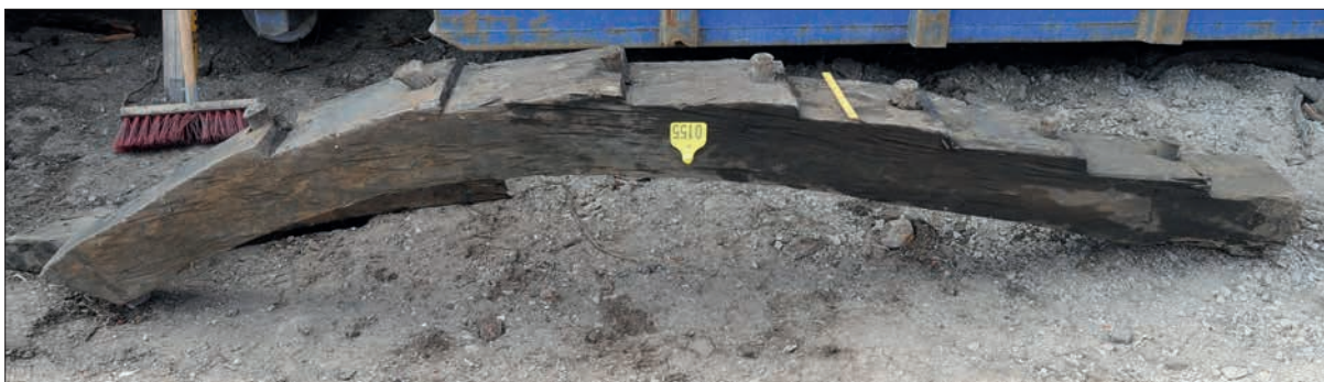
Fig. 7. Spant med trädymlingar (155) från ”Vrak 1”. Längden är cirka 3 meter, bredd 18 cm. Klinkhaken för bordläggningen är 25–30 cm.
