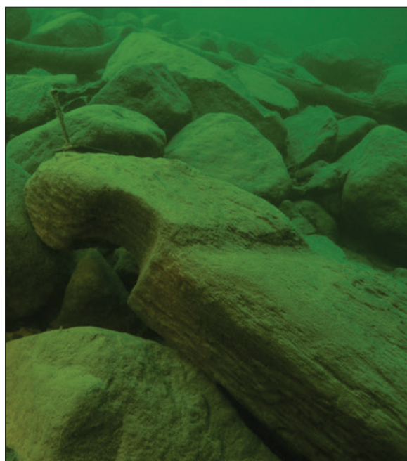
Fig. 12. Här syns det kvadratiska urtaget (röd pil) som en däcksbalk förmodligen har vilat i. Foto: Jim Hansson, Sjöhistoriska museet.
