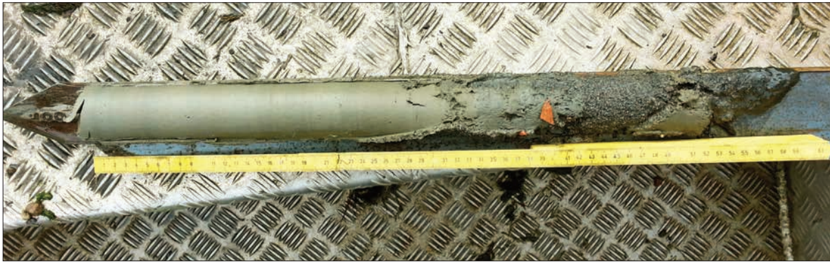
Fig. 11. Ryssborrprov nummer 2 (se fig. 10). Den vänstra halvan av provet består av en slät postglacial lera och den högra består av sand och grus med enstaka tegelfragment. Foto: Jens Lindström/Sjöhistoriska museet.
