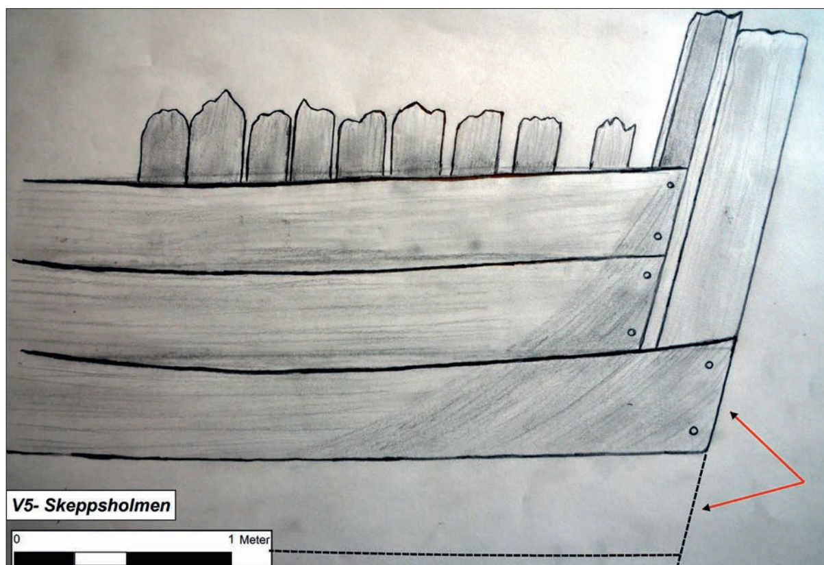
Fig. 24. Den här schematiska skissen visar att de nedre borden (på vraket syns bara det översta ovan botten) löper hela vägen ut till akterstävens slut. Exakt likadan konstruktion kan man bland annat se på Vasa. Skiss: Jim Hansson, Sjöhistoriska museet.
