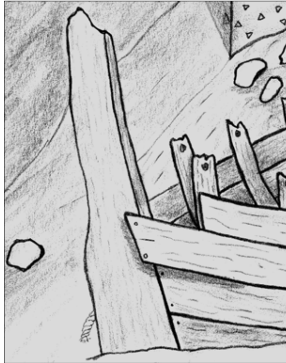
Fig. 12. Detta är en schematisk skiss av Solens akterstäv som visar status på botten men också hur bordläggningen placerats. Skiss: Jim Hansson, Sjöhistoriska museet.
