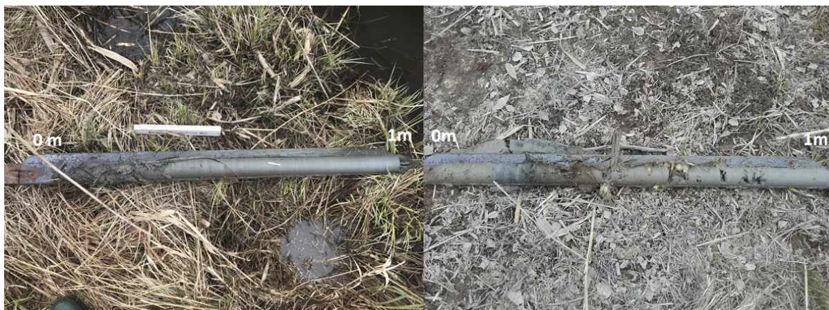
Figur 6. En meter djupa borrhovkärnor med växtmaterial. Provet till vänster är taget vid åmynningen, det till höger vid pålarna. Foto: Mikael Fredholm, Statens maritima museer.
