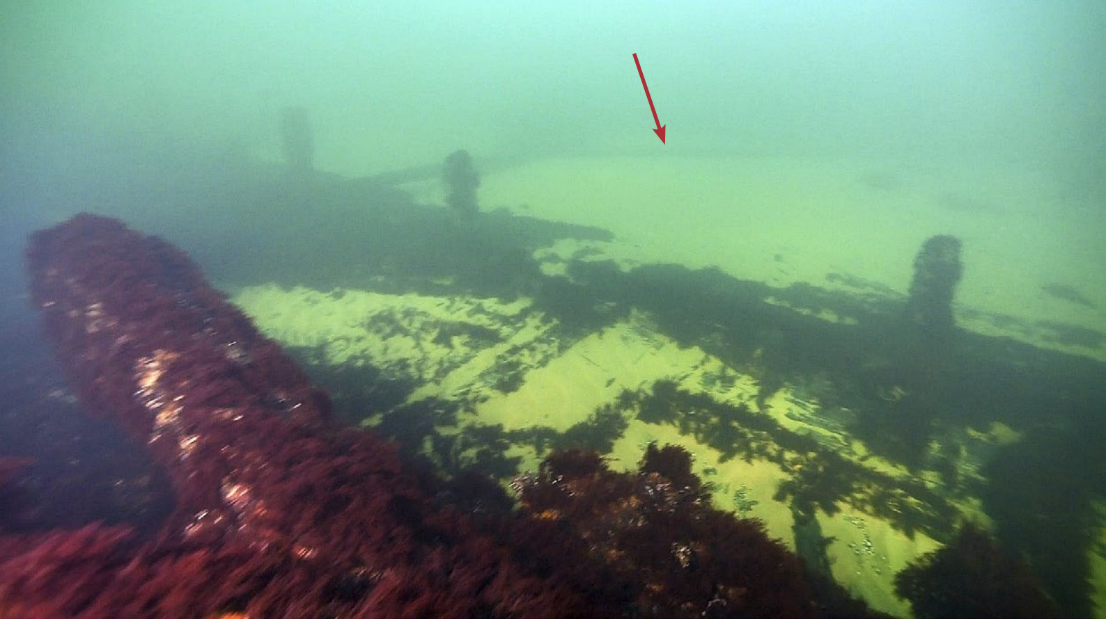
Figur 15. Styrbordssidan som ligger platt på botten. Knäna för däcksbalkarna pekar rakt upp mot ytan. Bilden är tagen i höjd med ångpannan. Notera timmer som ligger längre bak i bilden (röd pil). Foto (från video): Jim Hansson, Statens maritima museer.
