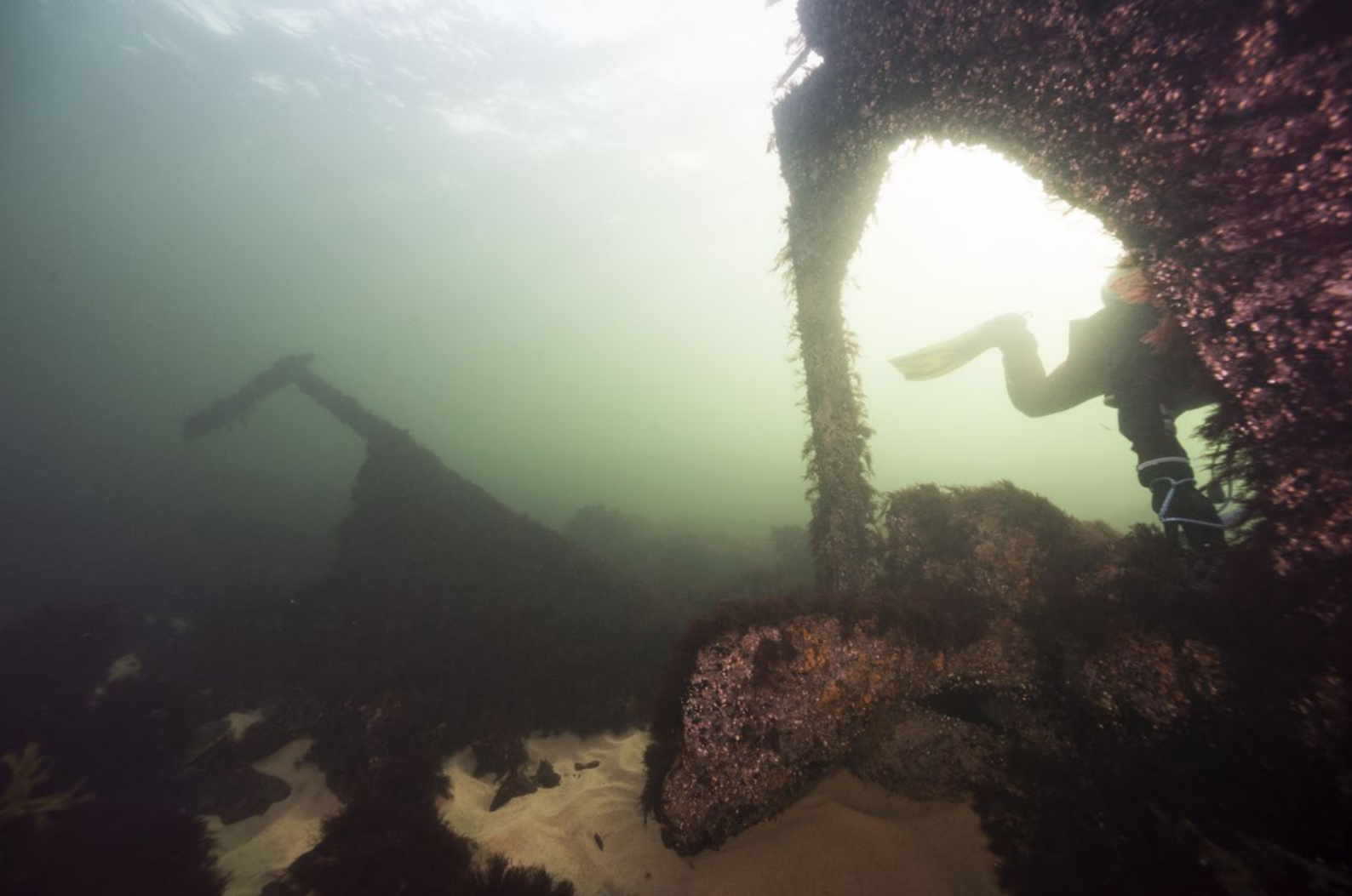
Figur 18. Ett av propellerbladen på styrbordssidan sitter på sin ursprungliga plats. Däremot är det oklart om propellern saknar ett eller två blad. Foto: Jim Hansson, Statens maritima museer.
