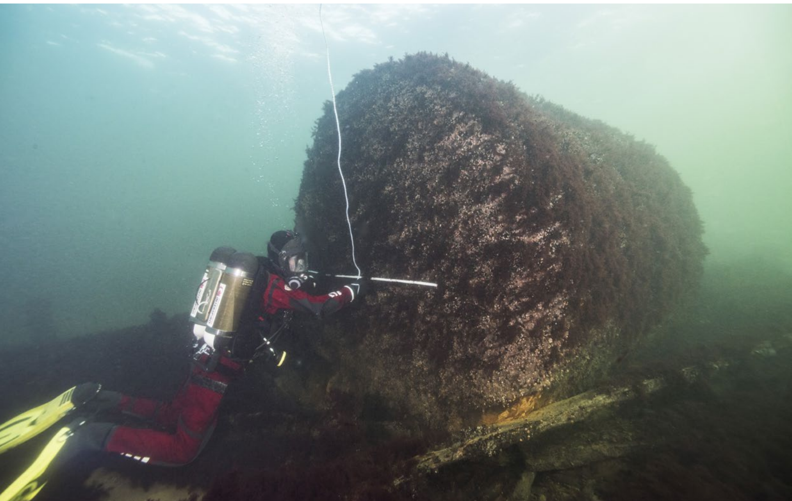
Figur 19 (nedan). Ångpannans ena ände som vetter mot fören mäts av dykaren. Diametern är 2,50 meter. Foto: Jim Hansson, Statens maritima museer.
