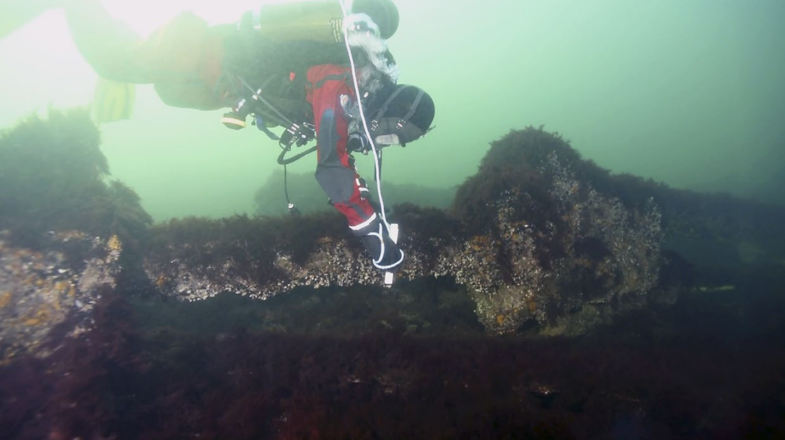
Figur 17. Bilden visar den kraftiga propelleraxeln som fortfarande sitter i ursprungligt läge. Foto (från video): Jim Hansson, Statens maritima museer.
