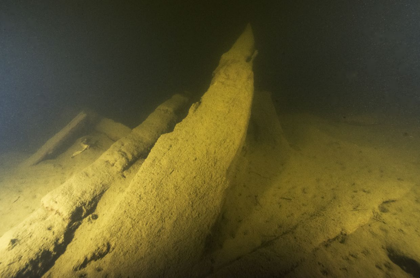
Figur 17. Förstävén ligger lutad mot babordssidan. Förliga partiet är väldigt fragmenterat. Notera det klinkbyggda spantet vänster om stävén. Foto: Jim Hansson, Statens maritima museer.
