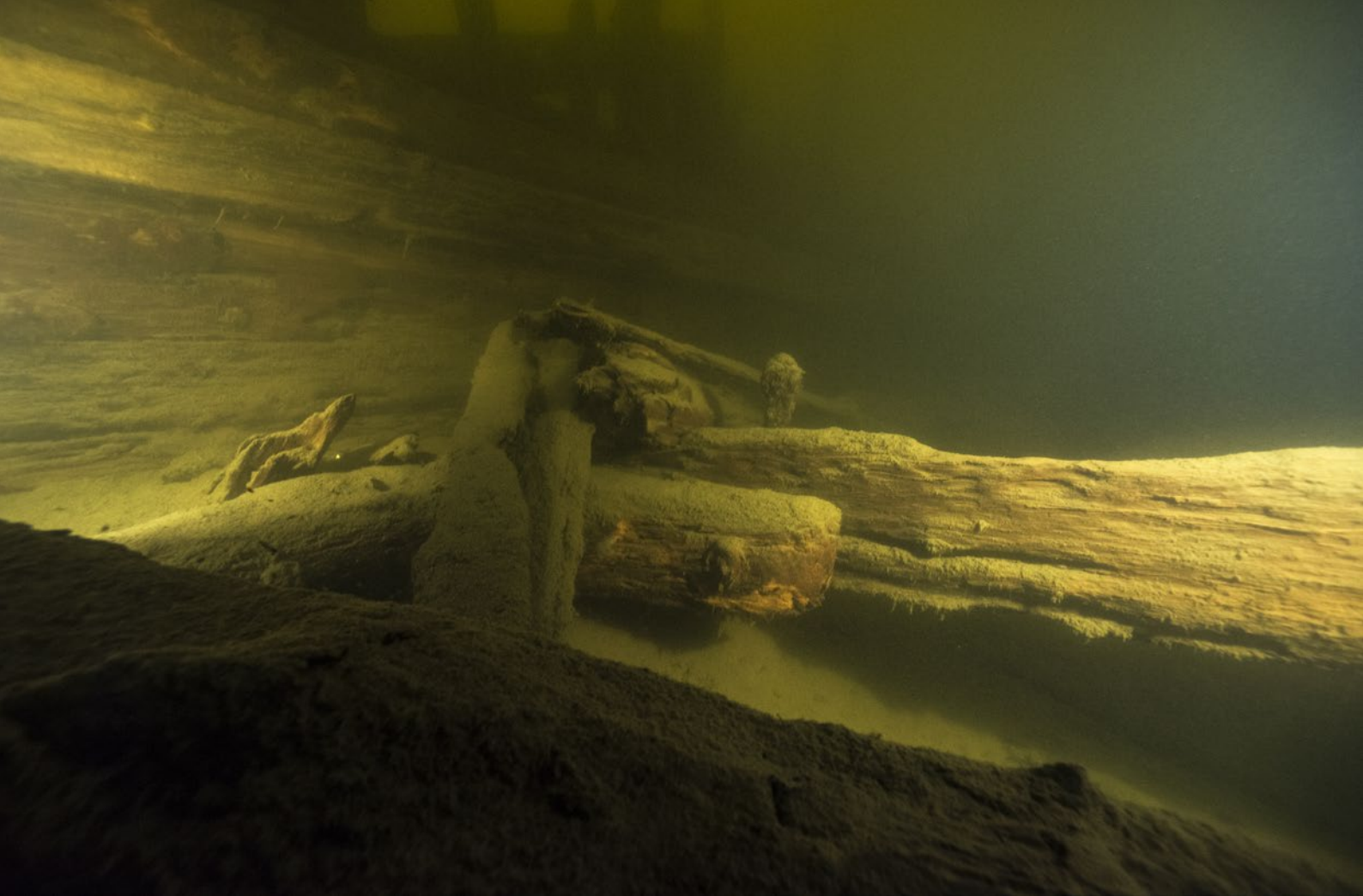
Figur 8. Däcksbalken sitter fortfarande i sitt läge strax ovan sedimenten i skeppet. Knät som förstärker balken sitter till vänster om balken på babordssidan. Den kraftiga innergarneringen syns också tydligt på bilden. Foto: Jim Hansson, Statens maritima museer.
