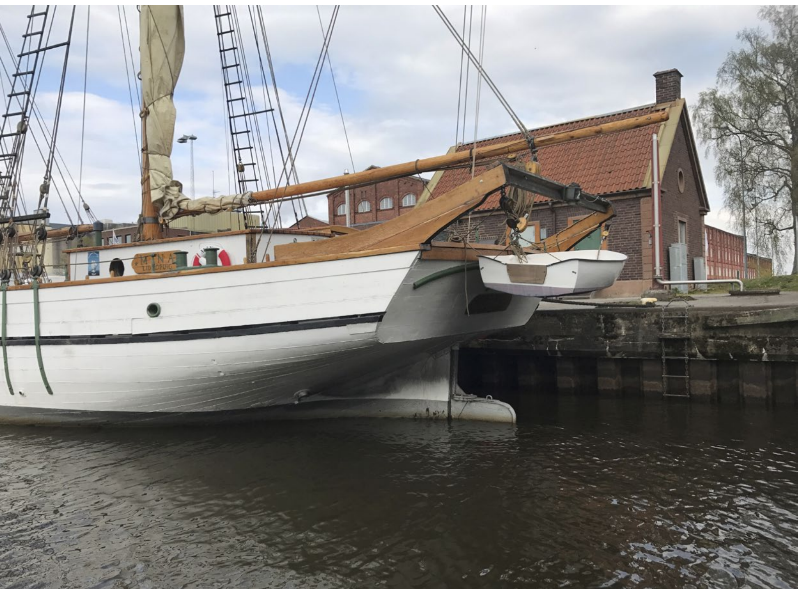
Figur 21. Aktern på galeasen MINA är renoverad och därför skiljer sig exempelvis rodret kraftigt från det på RAÄ 890. Foto: Jim Hansson, Statens maritima museer.
