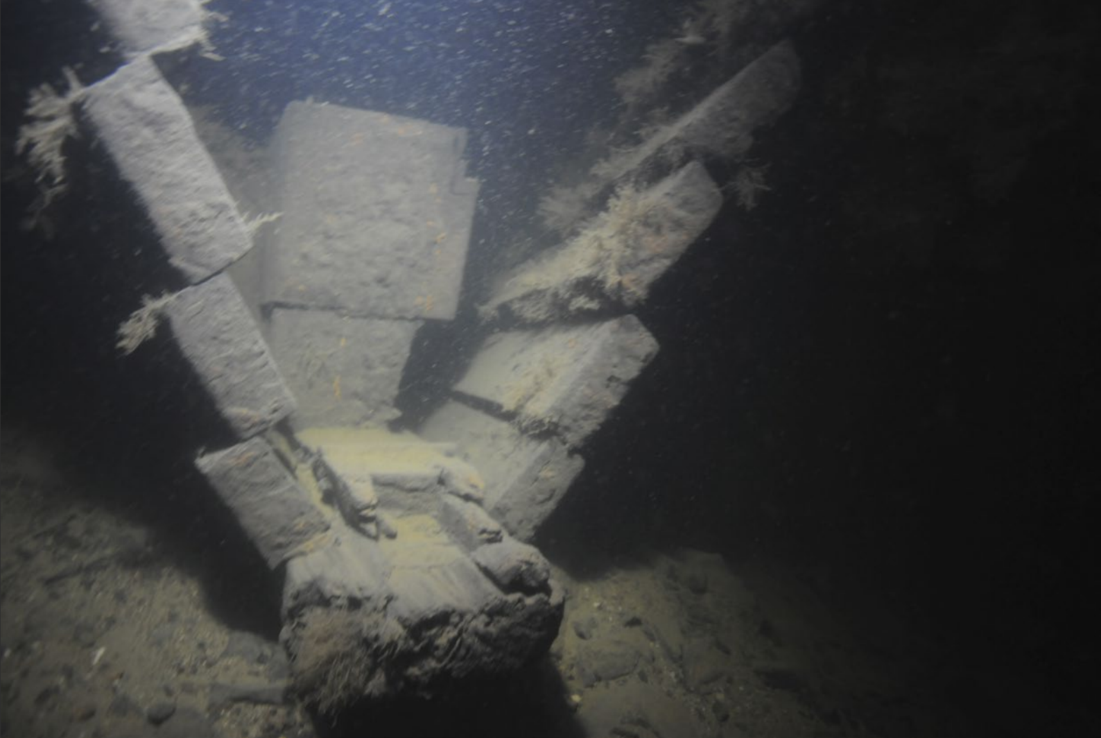
Figur 7. Här syns skrovets akterparti med de kravellagda bordläggingsplankorna och urtaget i kölen där akterstaven en gång suttit. Foto: Jens Lindström, Statens Maritima Museer.
