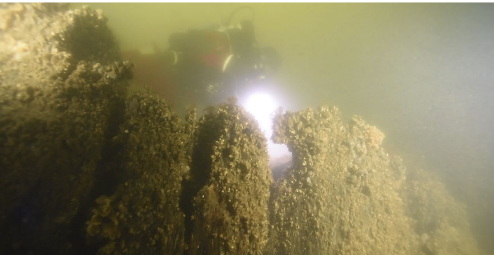
Figur 16. Fartyget var kraftigt byggt med spanten mycket tätt intill varandra. Foto: Jim Hansson, Statens maritima museer.
