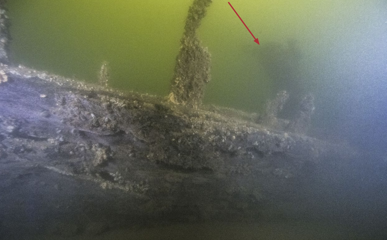
Figur 24. Skrovet är relativt intakt i stora delar av lämningen V3. Spanten är kraftigt eroderade ovan bordläggningsnivån. Notera däcksknät på insidan av skeppet (röd pil). Foto: Jim Hansson, Statens maritima museer.
