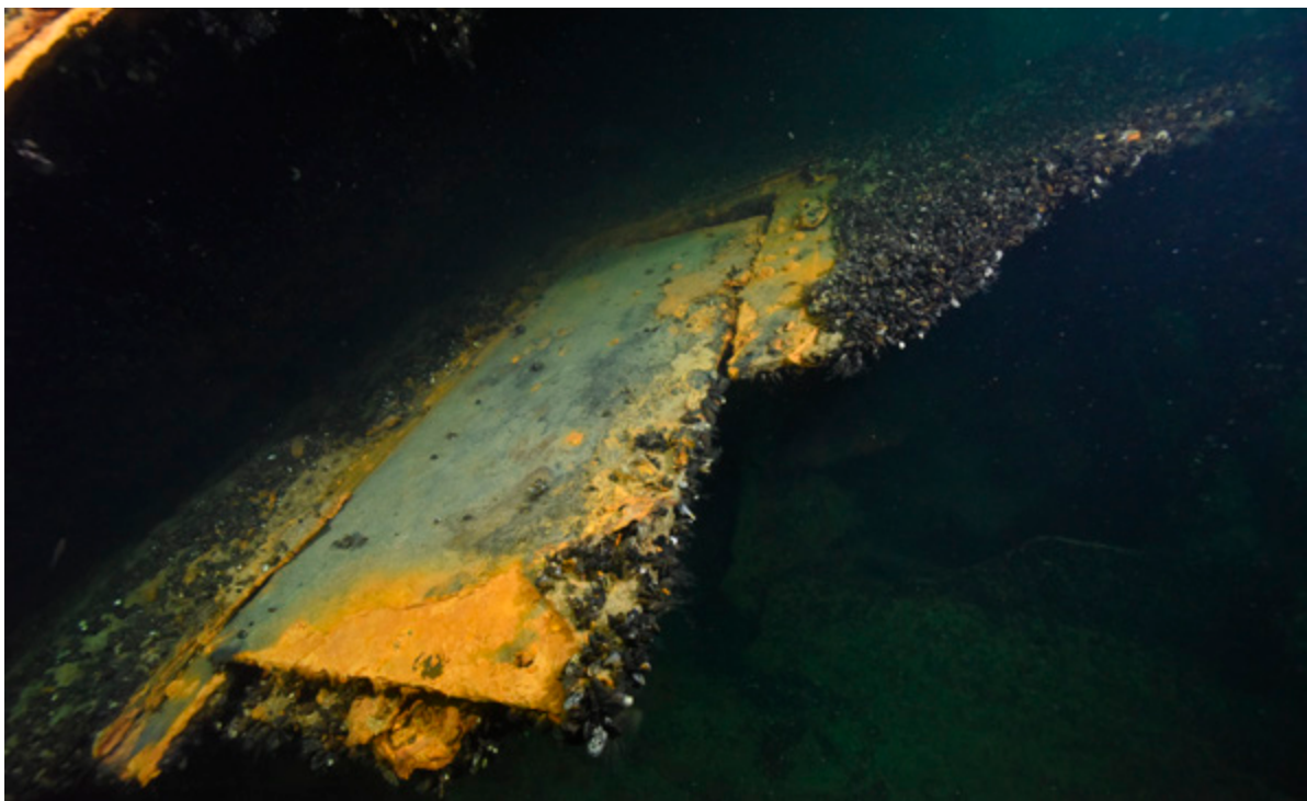
FIG. 10 Skrovplåtar som fläkts ut på styrbords sida i förpartiet på Princess . Foto: Mikael Fredholm, Statens maritima museer.
