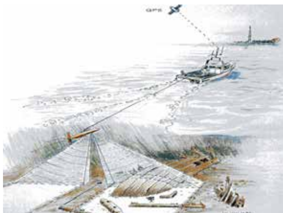
FIGUR 52. Teckningen visar en side scan sonar som släpas efter en båt. Göran Ulrich, SMTM 1994.
