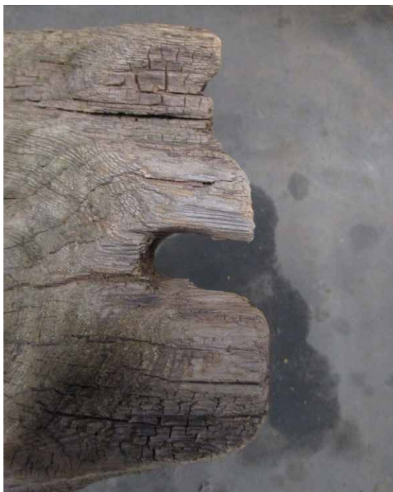
FIGUR 7. Borrat vertikalt hål genom förstäven. Foto: Lotta Mejsholm, SMTM (Digitalt museum: Fo223400DIG).
