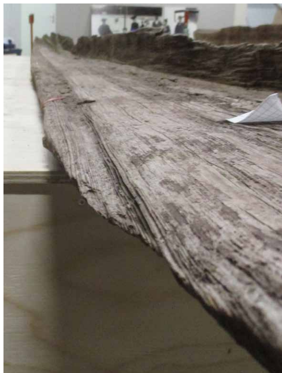
FIGUR 6. Urfasning i botten för stödjande element, kölsvin. Foto: Lotta Mejsholm, SMTM. (Digitalt museum: Fo223399DIG)
