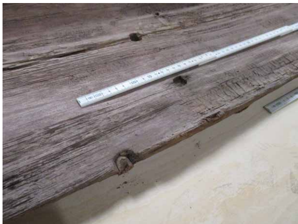
FIGUR 5. Dymlingshål vertikalt och horisontellt för sammanfogning i stockbåtsbotten. Foto: Lotta Mejsholm, SMTM (Digitalt museum: Fo223398DIG) .
