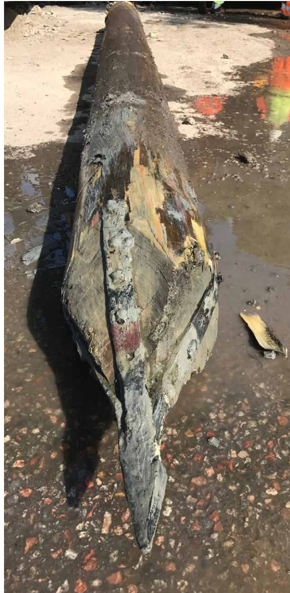
FIGUR 16. Flera stockar påträffades med smidda järnspetsar. Foto: Jim Hansson, Statens maritima och transporthistoriska museer. Digitalt museum: Fo223334DIG.
