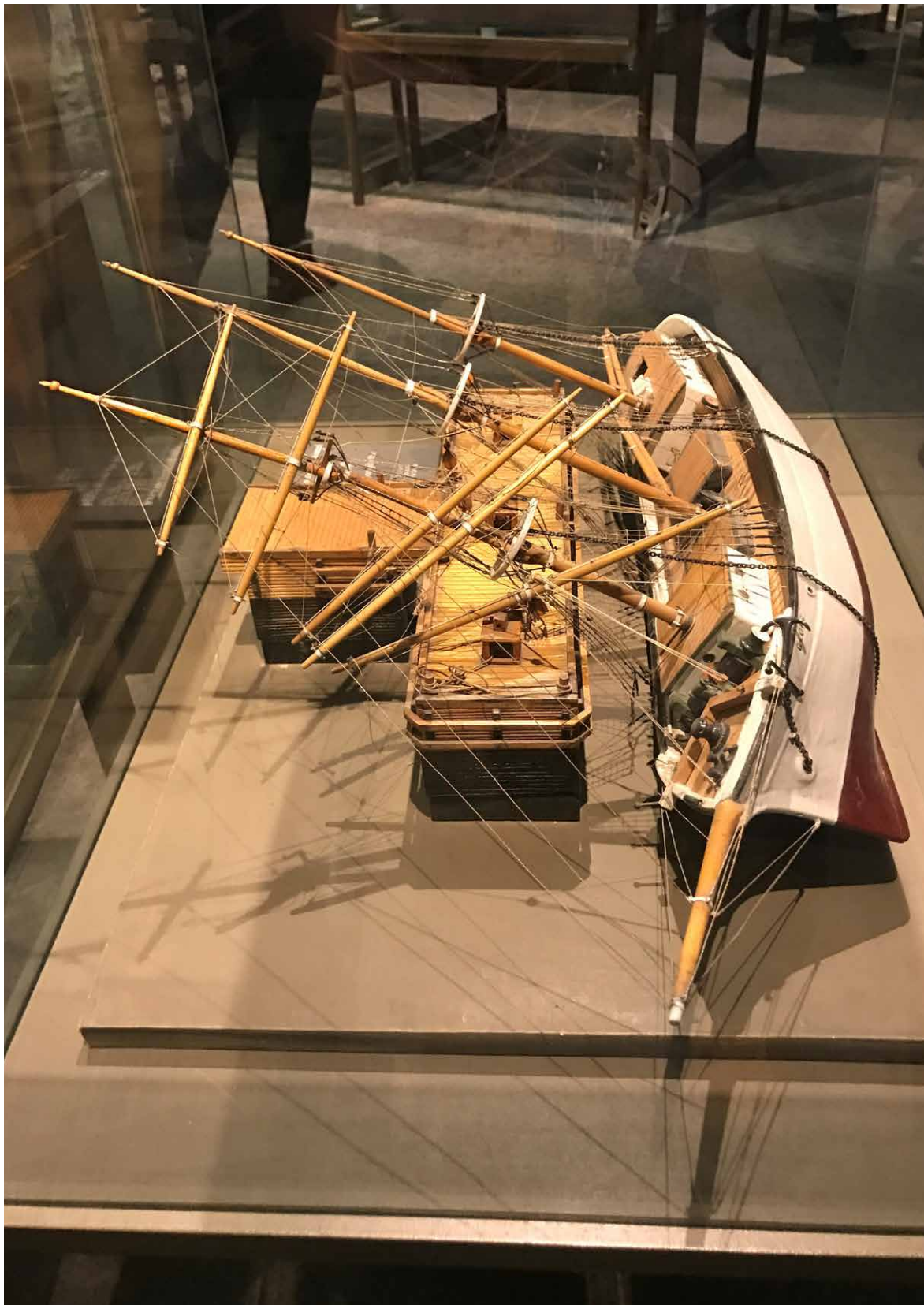
FIGUR 4. Bilden visar hur ett fartyg vindas ned på en Krängningsbro/brobänk för att komma åt att kalfatra samt reparera skrovet. Modell från Sjöfartsmuseet i Tallinn. Foto: Jim Hansson, Statens maritima och transporthistoriska museer. Digitalt museum: Fo223323DIG.
