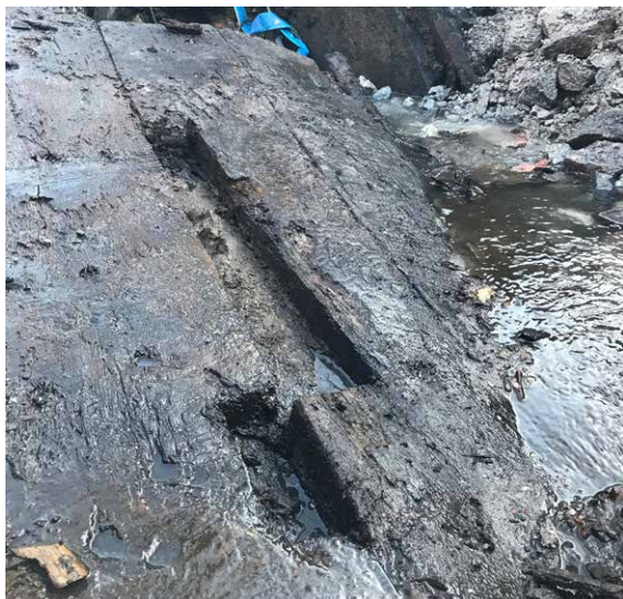
FIGUR 27. Bilden visar två hål för lagningsbitar. Under dessa kommer först en matta med tjära sen det yttre påspikade skrovet. Foto: Jim Hansson, Statens maritima och transporthistoriska museer. Digitalt museum: Fo223344DIG.
