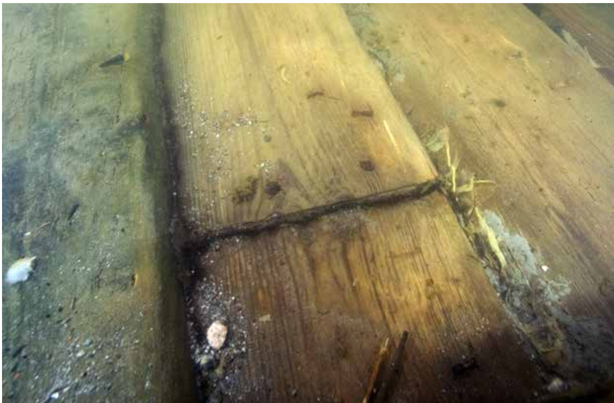
FIGUR 8. Förstoring av fig. 7. Från vänster: Kölen, sambordet (med lask). Spikar och omböjda spikar kan ses i mitten av bilden. Foto: Jim Hansson, Statens maritima och transporthistoriska museer.
