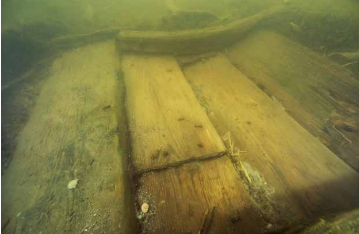
FIGUR 7. Foto längst "akterut". Från vänster: Kölen, sambordet (med lask) och två bordläggningsplankor. Spikar och omböjda spikar kan också ses i mitten av bilden. Foto: Jim Hansson, Statens maritima och transporthistoriska museer.
