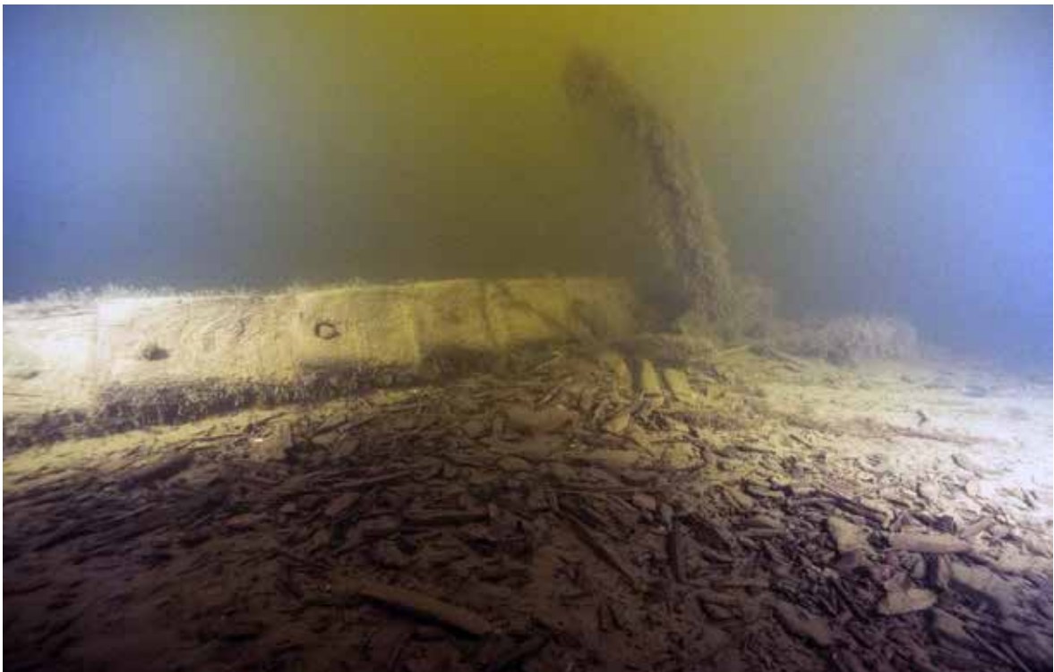
FIGUR 12. Ett spant med klinkhak. Notera det kraftiga kulturlagret av huggspån. Foto: Jim Hansson, SMTM. Digitalt museum: Fo223534.
