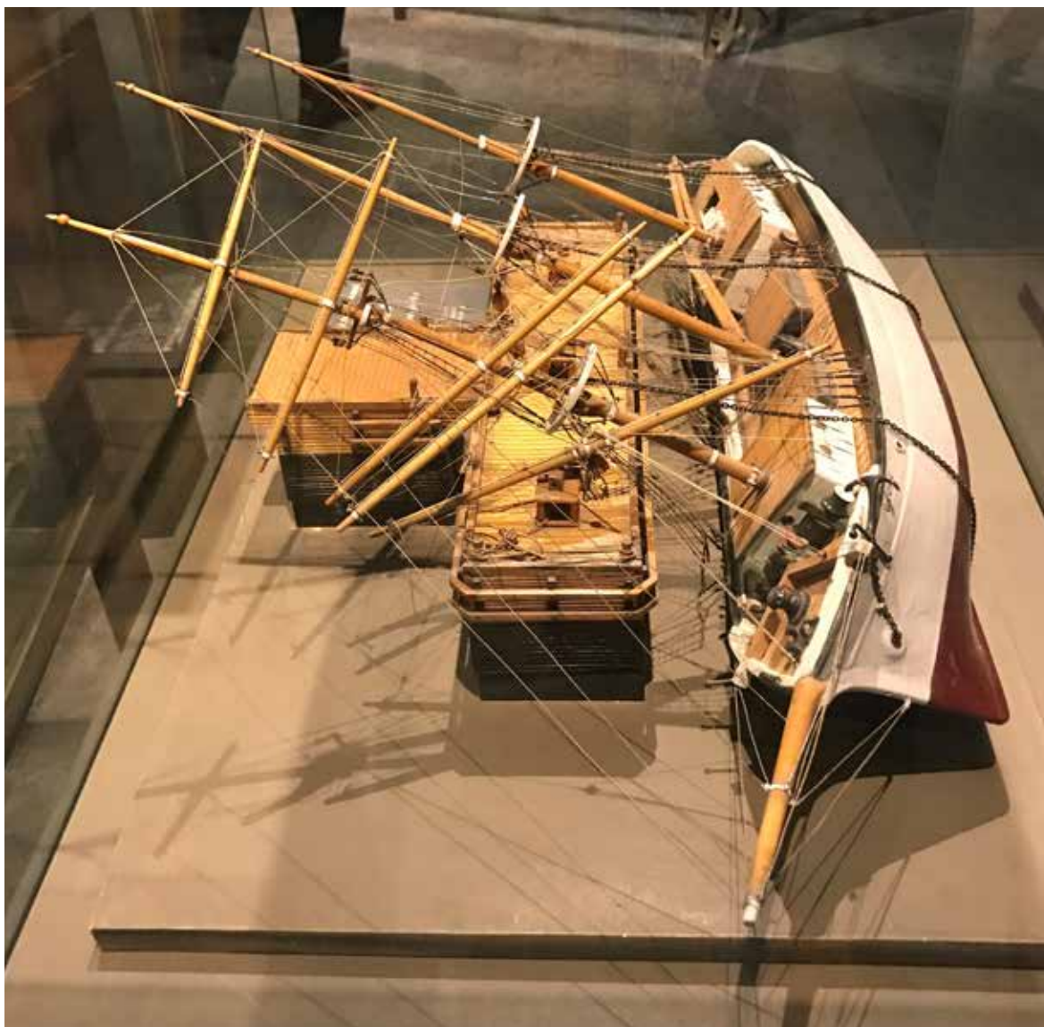
FIGUR 3. Bilden visar hur ett fartyg vindas ned på en brobänk för att komma åt att kalfatra samt reparera skrovet. Modell från Sjöfartsmuseet i Tallinn. Foto: Jim Hansson, SMTM. Digitalt museum: Fo223527.
