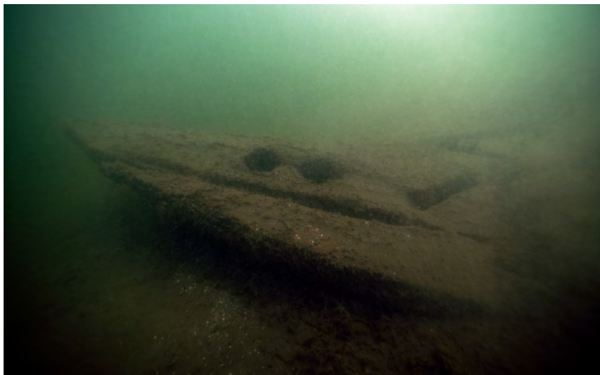
FIGUR 20. Förstäven ligger lös på botten framför fören. Stäven är svagt böjd och sedan spetsig mot slutet. Notera hålen och det rektangulära hålet. Dessa har haft förbindningar i form av tross som hållit det ovanpåliggande bogsprötet på plats. Foto: Jim Hansson, SMTM. (Digitalt museum: Fo223591).
