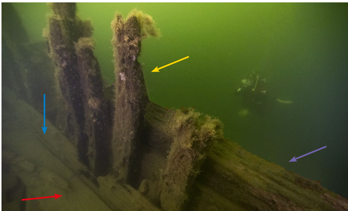
FIGUR 20. Bilden är tagen inne i vraket mot styrbordssidan. Röd pil visar en däcksplanka/vaterbord, blå visar innergarneringen, gul visar spanten och lila visar berghultet. Den dykande arkeologen befinner sig på utsidan en bit nedanför skrovsidan. Foto: Jim Hansson, SMTM. Digitalt museum: Fo223550.
