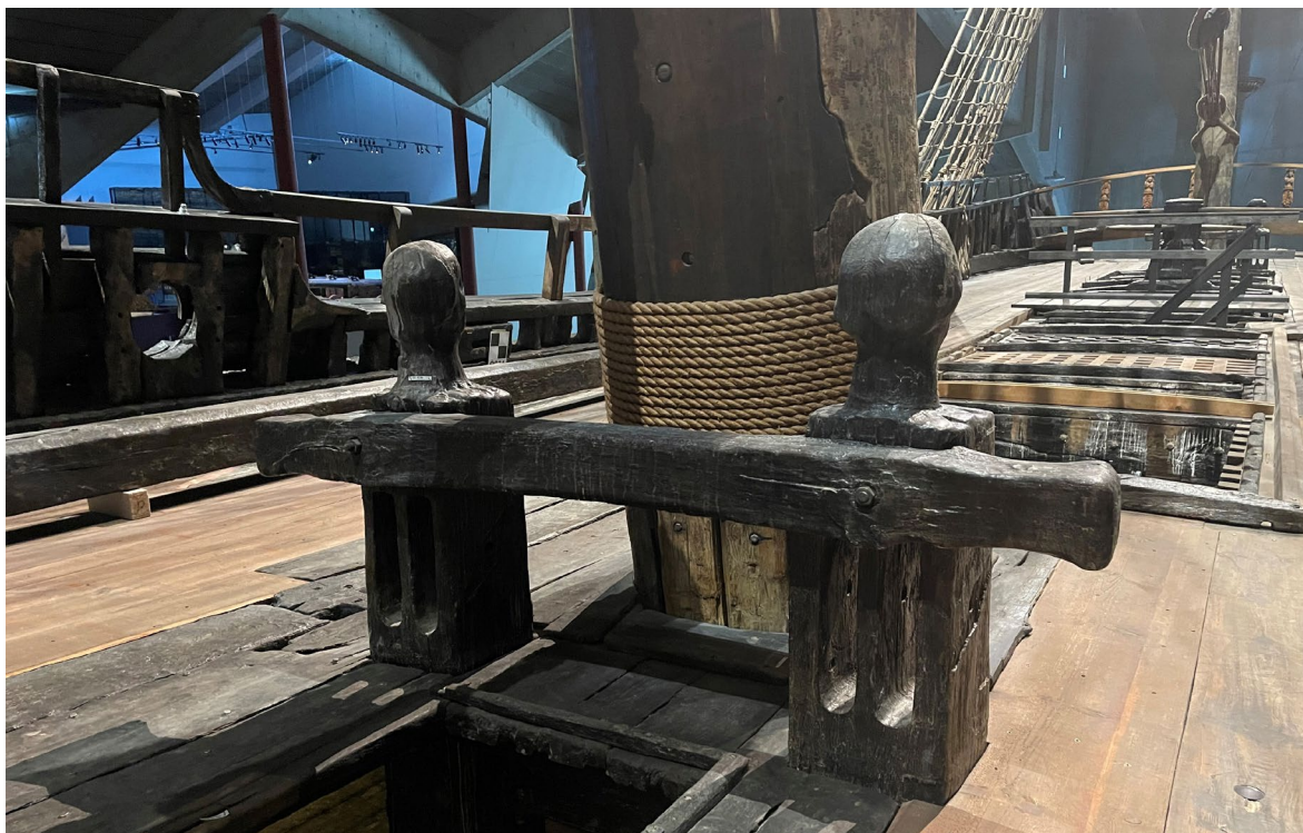
FIGUR 29. Knekt/beting på Vasas väderdäck av samma typ som påträffats på Vrak 1. Sannolikt har även den på Vrak 1 suttit på ett öppet däck. Foto: Jim Hansson, SMTM. Digitalt museum: Fo223559.
