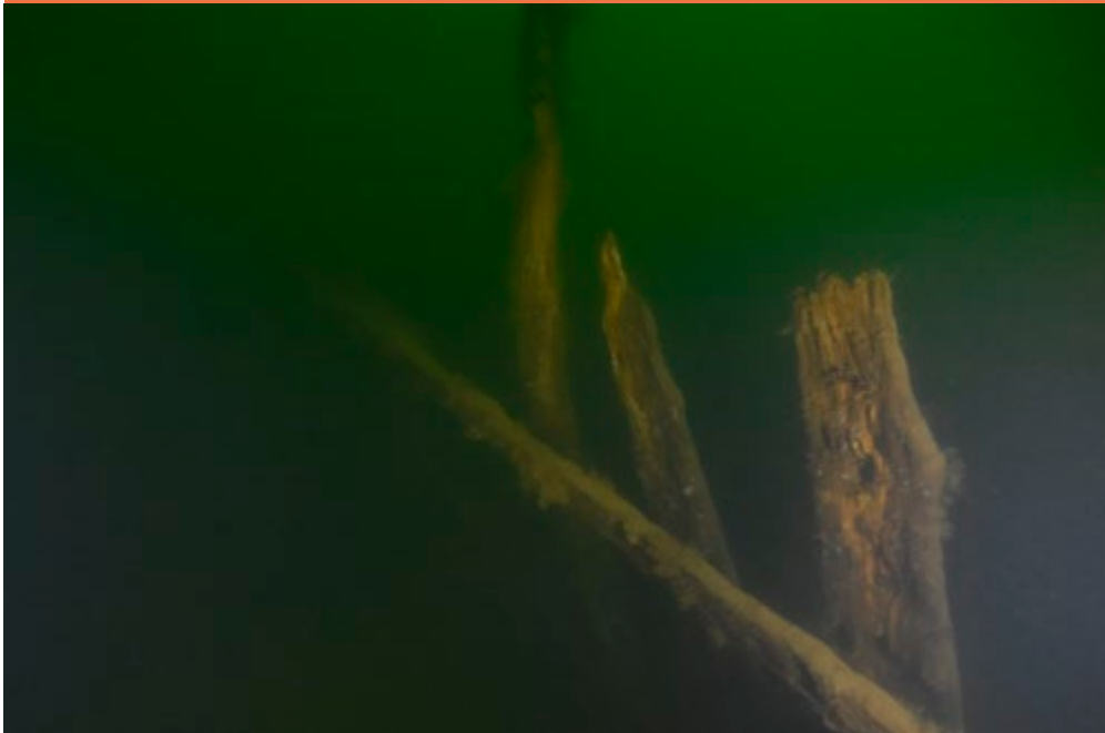
Styrbords skrovsida akterut, med en tunn eroderad ensam bordläggningsplanka, fotat utifrån (Foto: Håkan Altrock, SMTM). (Digitalt museum: Fo223490).
