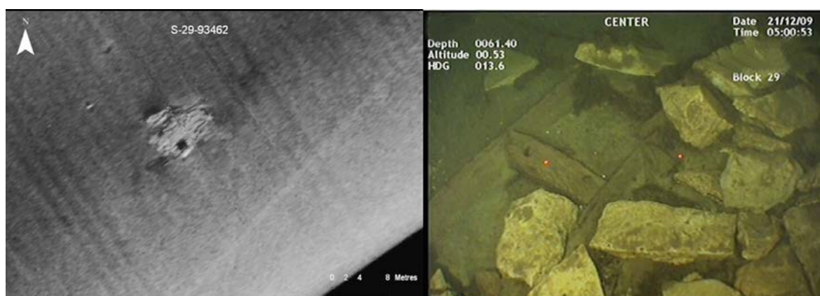
FIGUR 3. Sonarbild och ROV-bild från en kalkstensfylld fartygslämning, som påträffades längs med gasledningen Nord Stream i Östersjön (Fredholm 2010:27f)
