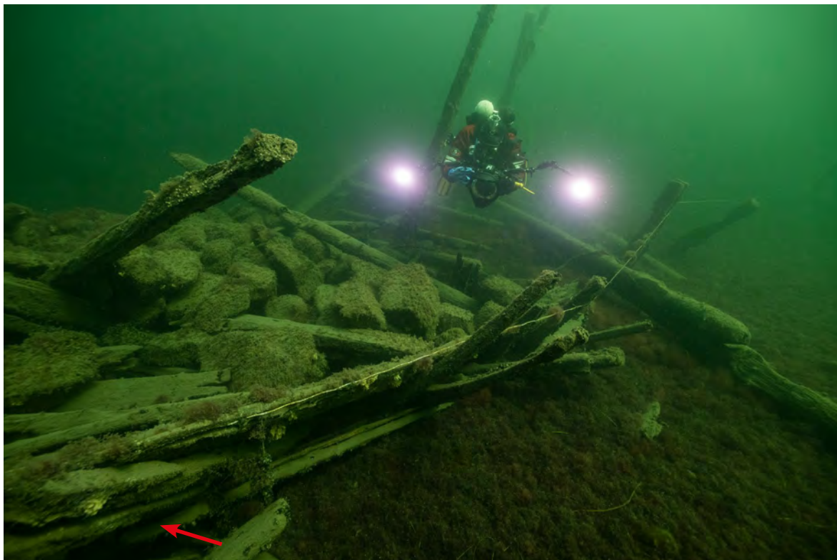
FIGUR 56. Den röda pilen visar änden på skarven. Foto: Jim Hansson, SMTM. Digitalt museum: Fo223667.
