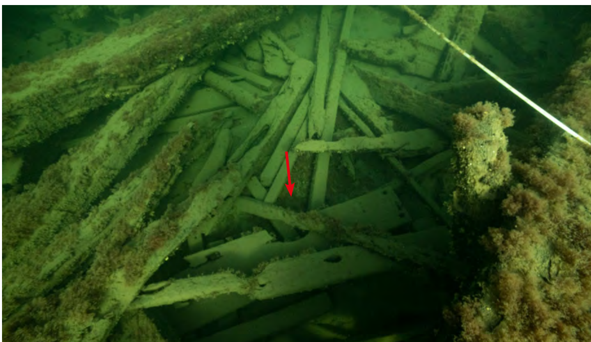
FIGUR 12. Mastfisken syns vid den röda pilen. Notera däcksbalken ovanför som även syns i figur 10. Foto: Jim Hansson, SMTM. Digitalt museum: Fo223627.
