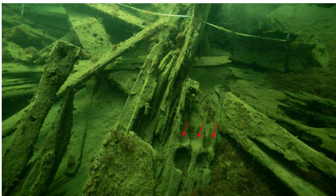
FIGUR 40. Kranbalkens yttre ände pekar upp i bilden. Urtagen för tre blockskivor är markerade med röda pilar. Foto: Jim Hansson, SMTM. Digitalt museum: Fo223653.
