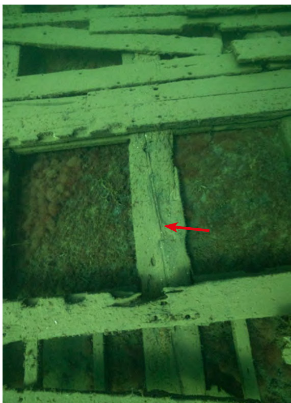
FIGUR 31. Den skarvade däcksbalken har en tydlig haklask (röd pil). Notera även urtagen för gretingarna. Foto: Jim Hansson, SMTM. Digitalt museum: Fo223644.
