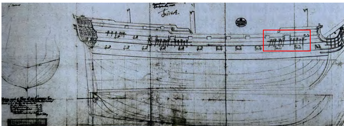
FIGUR 15. Skeppsbyggmästaren Harald Sohlbergs ritning av Uppland , systerfartyget till Södermanland/Gripen . Den röda rektangeln visar ungefär var det nedfallna skrovpartiet suttit. Källa: Svenska flottans historia 1943 II:191.
