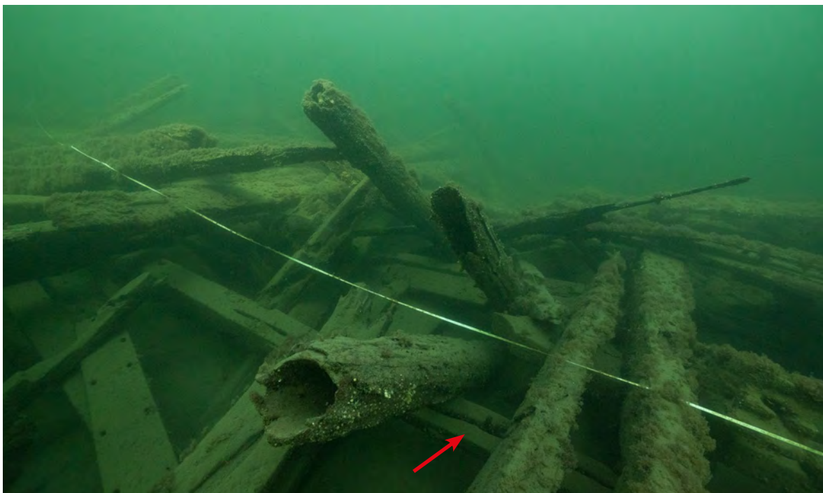
FIGUR 26. På bilden syns tre av sex pumpar. Notera även den skarvade däcksbalken under pumparna, markerad med röd pil. Foto: Jim Hansson, SMTM. Digitalt museum: Fo223639.
