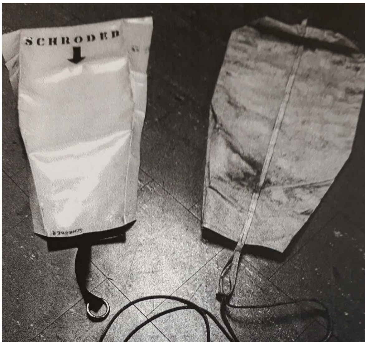
FIGUR 5. Två lyftsäckar som används för att kunna bärga föremål och annat från botten. Foto: från SMA arkiv SMA 6145:008. Omfattas ej av CC BY-licens.
