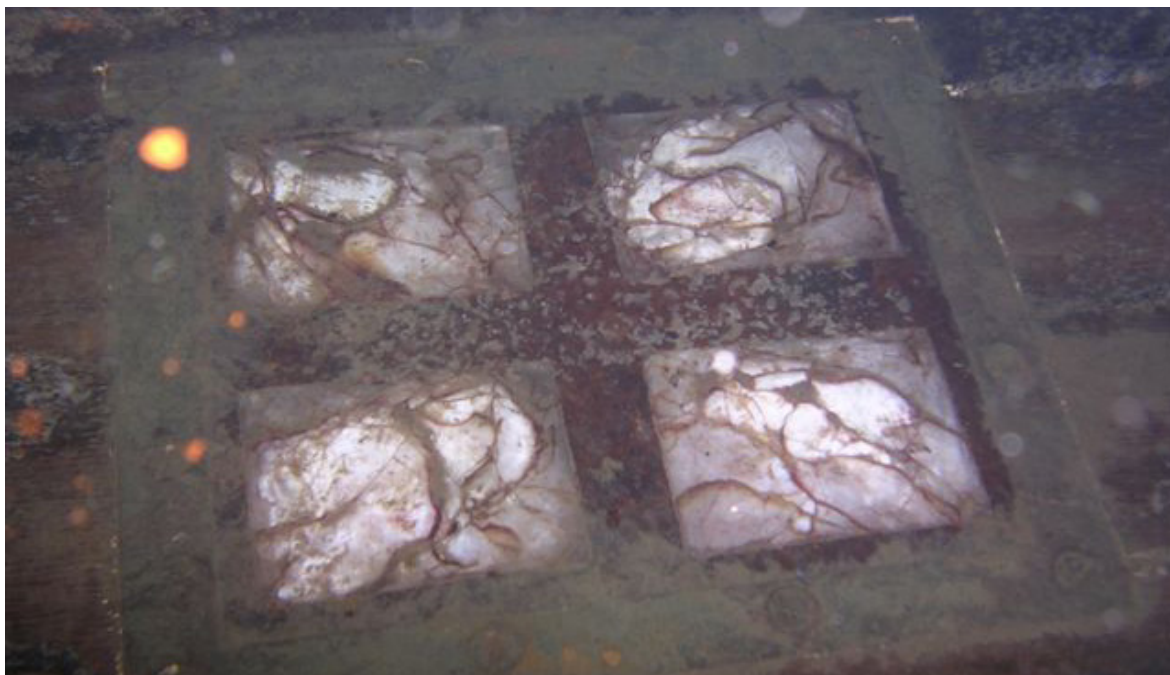
FIGUR 10. Prisma, som släpper in ljus under däck, på backen (fördäcket). War Fundy. Foto: Torbjörn Gylleus, 2005. © Torbjörn Gylleus.
