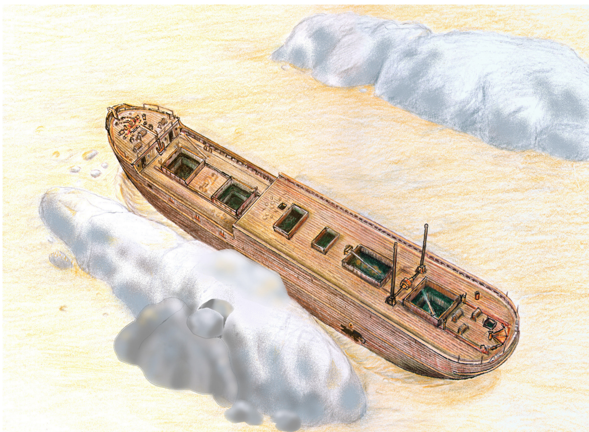
FIGUR 11. Skiss av War Fundy visar att hon vid upptäckten var skrovhel, men bland annat styrhytten har försvunnit eller rasat ihop. Sonarbilden i bilaga 1 indikerar att hon ännu är skrovhel, men att hon sannolikt ligger mer på tvärs mellan grynnorna. Bild: Göran Ullrich, okänt år, SMTM.
