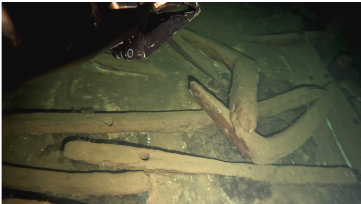
FIGUR 10. Fotostation 7. Knän och skeppssida på babords sida sedd förifrån. Foto: Kustbevakningen, 2024-08-04.
