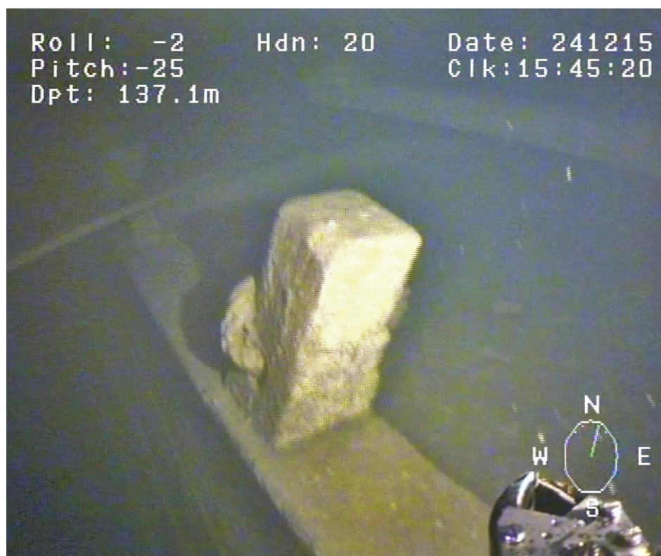
FIGUR 8. Fotostation 4. Pollare med tamp (för surring av rorkult) på babords sida. Rorkulten synlig i övre bildkant. Foto: Kustbevakningen, 2024-12-15.
