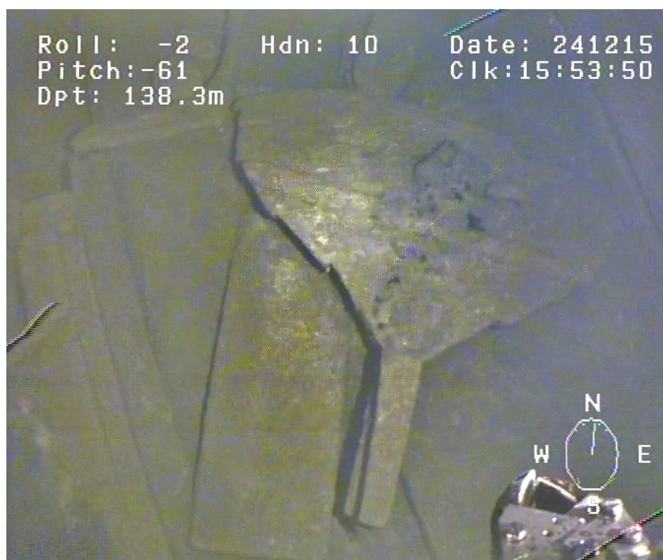
FIGUR 17. Fotostation 13. Akterspegel till en skeppsbåt på styrbordssidans däck.
