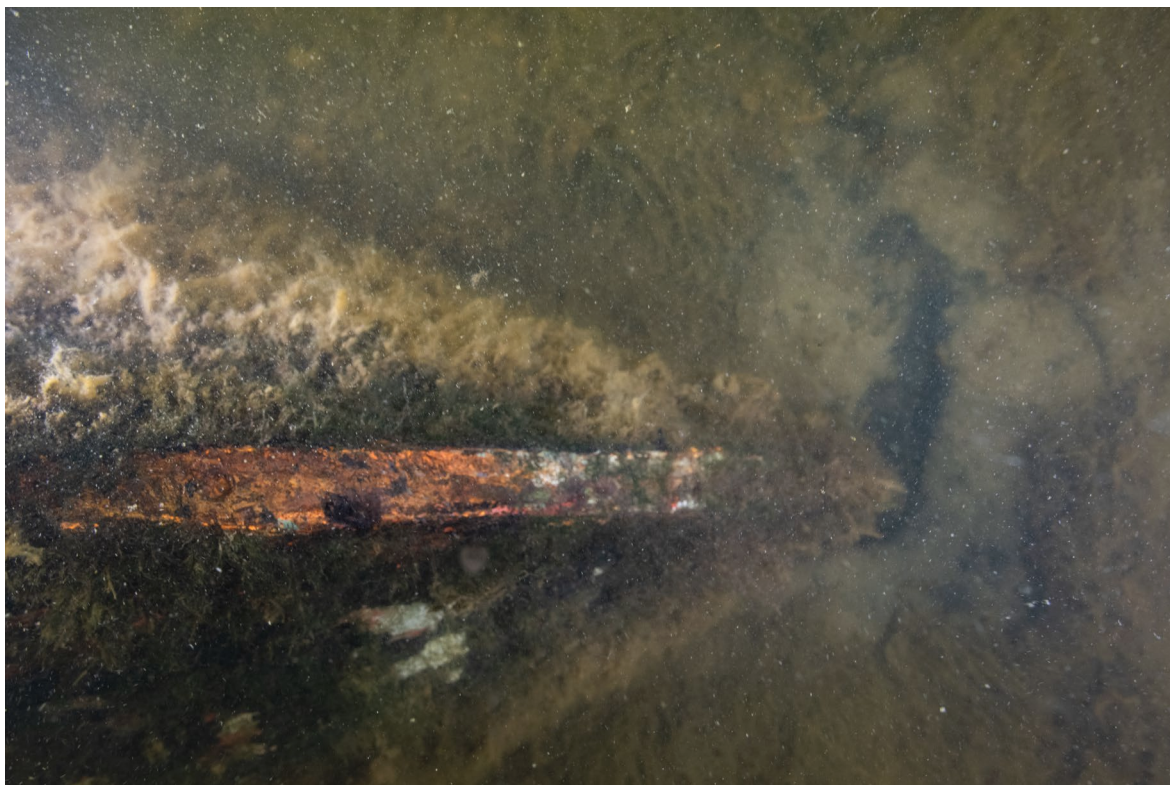
FIGUR 3. Vrakets förstäv sett ovanifrån. På den vänstra sidan av stäven syns spår efter en rund kopparnit. Foto: Marco Ali , SMTM (Digitalt museum: VK.V 0356).
