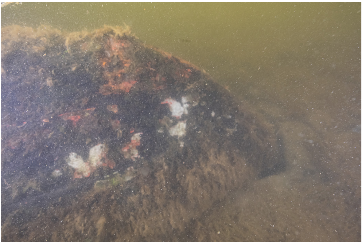
FIGUR 4. Vrakets babordssida samt förstäv. På bordläggningen finns spår av blymönja samt vit bottenfärg. Foto: Marco Ali, SMTM (Digitalt museum: VK.V 0357).
