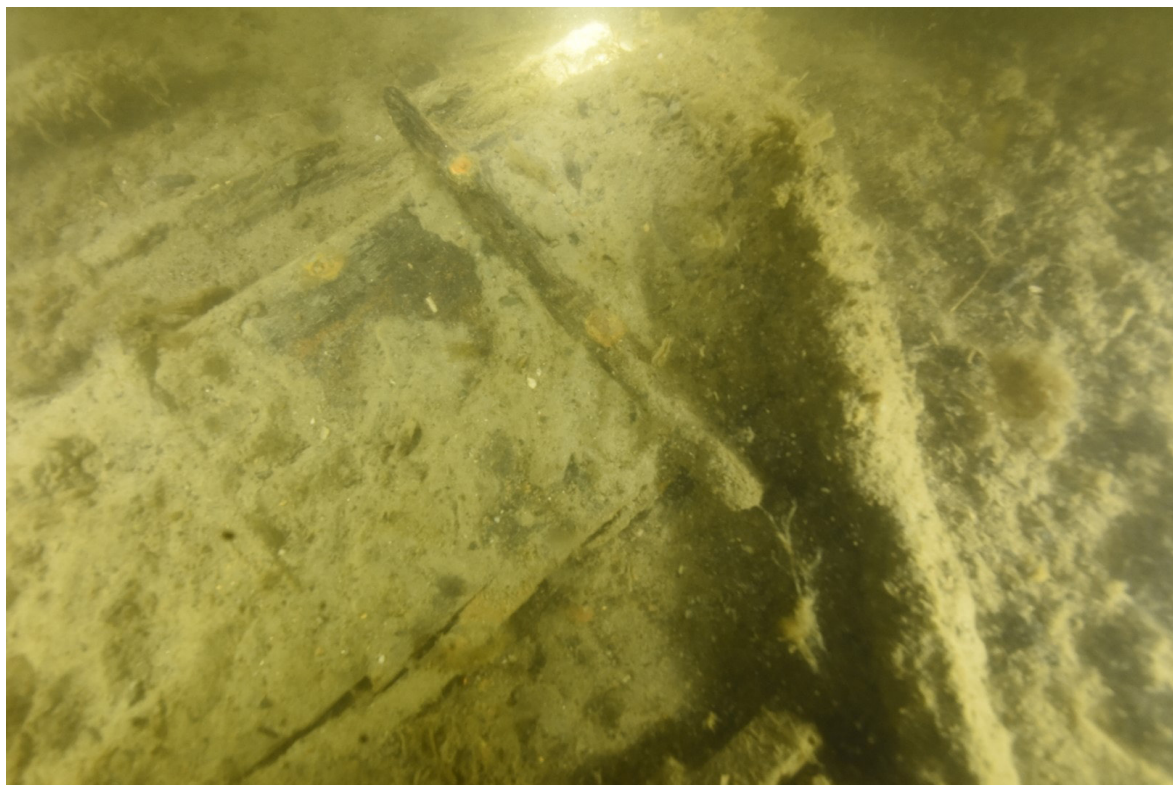
FIGUR 10. Bordläggning, klens spant med kopparnitar på den norra ekan. Foto: Marco Alí, SMTM. (Digitalt museum: VK.V 0335).
