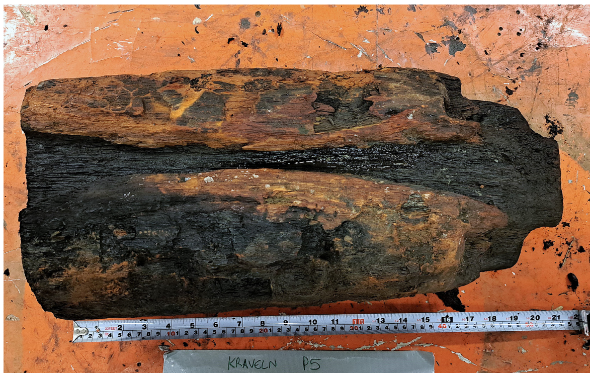
FIGUR 5. Prov 5–24. Tvärgående balk med uttag. Provet skall ha avverkats någon gång mellan 1518 och 1532. Bild: Marco Alí. SMMTF (Digitalt museum: VK. V 0493).
