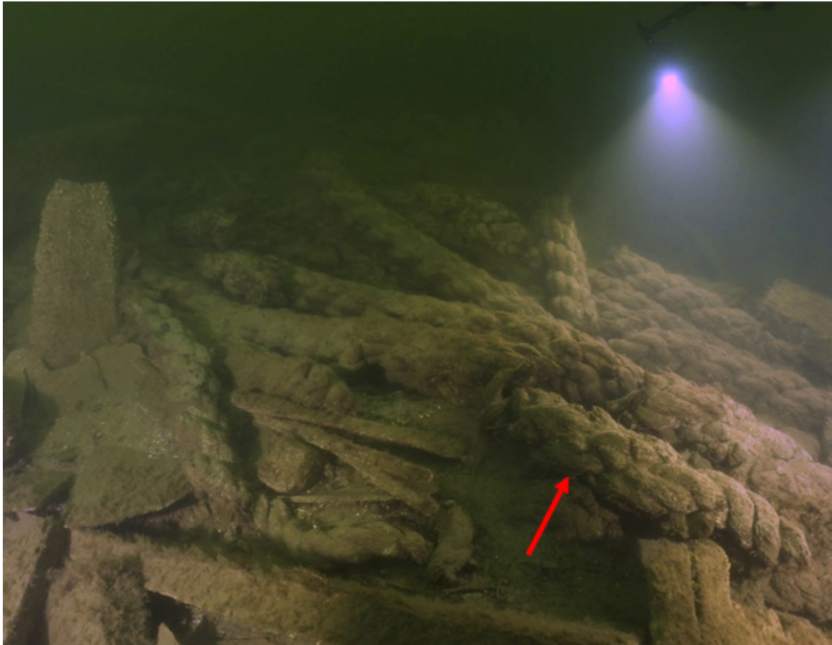
FIGUR 27. Ankarkabeln som ligger på trossdäcket har påverkats. En del av den har "brutits" av (röd pil). Fotat 13 mars 2025. Foto: Jim Hansson, SMTM.
