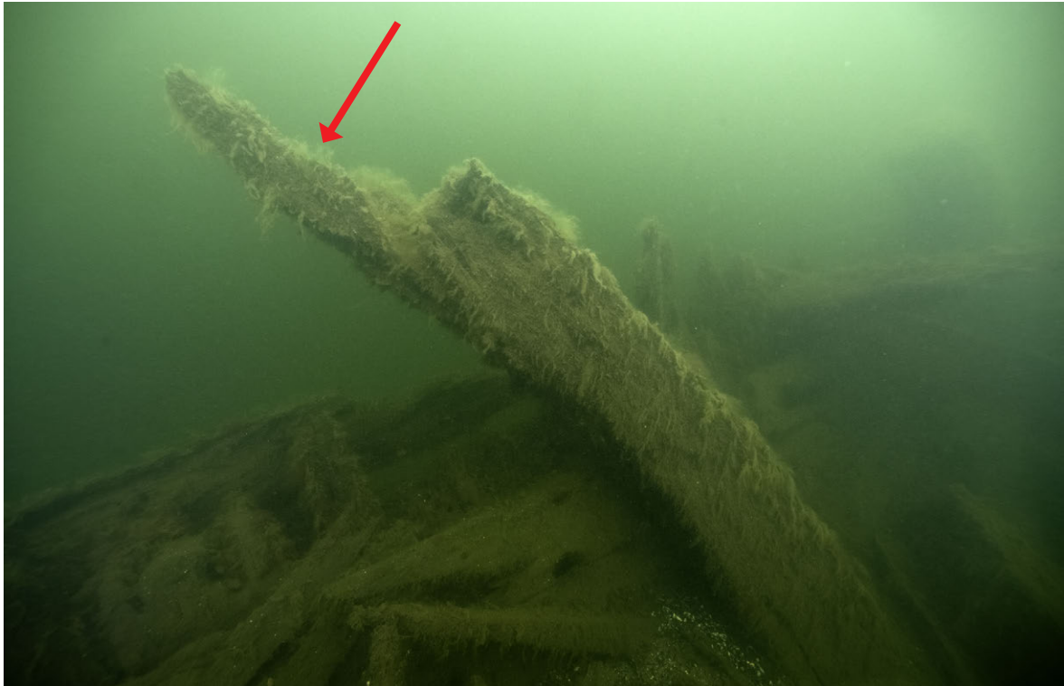
FIGUR 20. Stinnaren är ur sitt ursprungliga läge. Den röda pilen visar urtaget för balkvägaren, vilken suttit längsgående på insidan av skrovet. Foto: Jim Hansson, SMTM. VK.V 0281.
