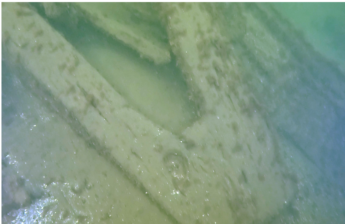
FIGUR 40. En bottenstock med en skarp V-formade vinkel. Foto: Jim Hansson, SMTM. VK.V 0295.
