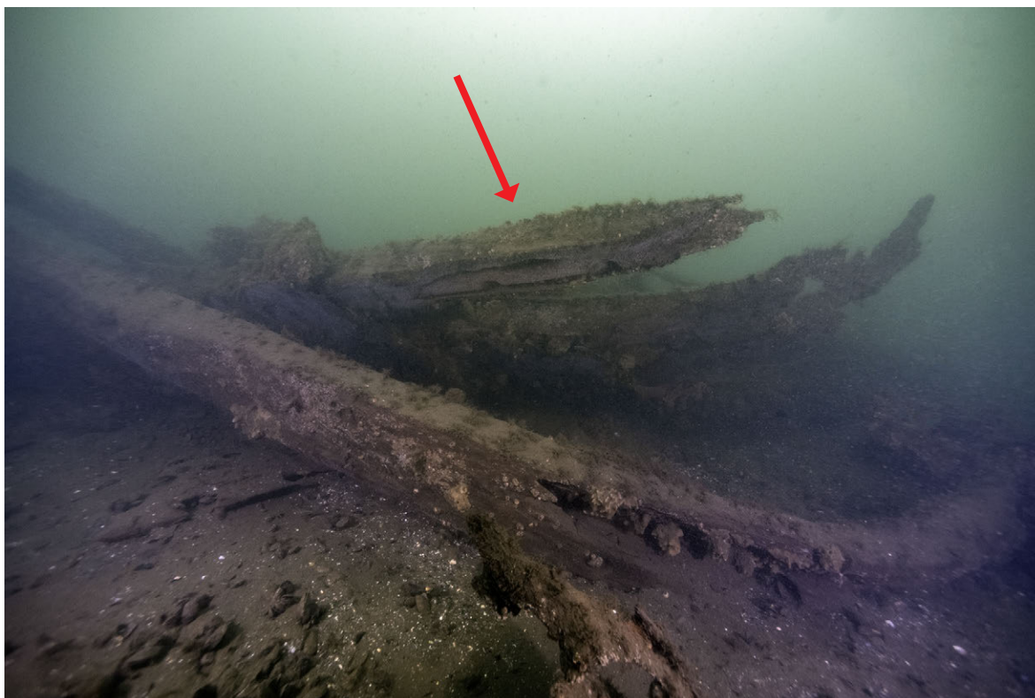
FIGUR 74. Bottenstockarna är väldigt flacka, här på styrbordssidan (röd pil). Foto: Jim Hansson. SMTM. VK.V 0322.
