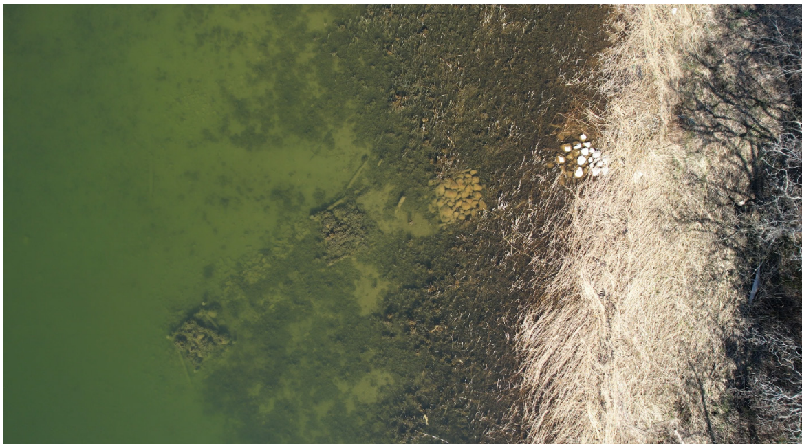
FIGUR 21. De fyra stenkistorna i Sotholmsviken, vilka utgör en urlastningsbrygga åtminstone för 1800-talets tegelbruk. Foto: Marco Alí, SMMTF. (Digitalt museum: VK. V 0446).
