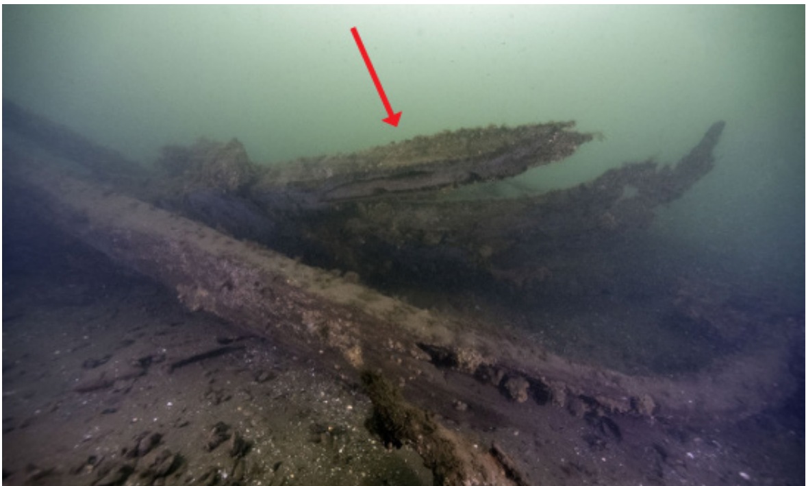
FIGUR 64. SM 09 som troligen är bojort no 17. Här avslöjar bottenstockar (röd pil) hur flatbottnad bojorterna var. Foto: Jim Hansson, SMMTF.
