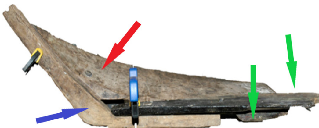
FIGUR 41. Ena stäven på båt IV ur Vasas småbåtsmaterial. Blå pil visar det vinklade stycket som utgör stäven (avbruten) och kölens främsta del. Den ansluter till kölplankan (gröna pilar) som består av en bred horisontell del och en låg vertikal del. Röda pilen markerar en vinda utklaven ur ett vridet stycke trä. Foto: Håkan Altrock: SMMTF.
