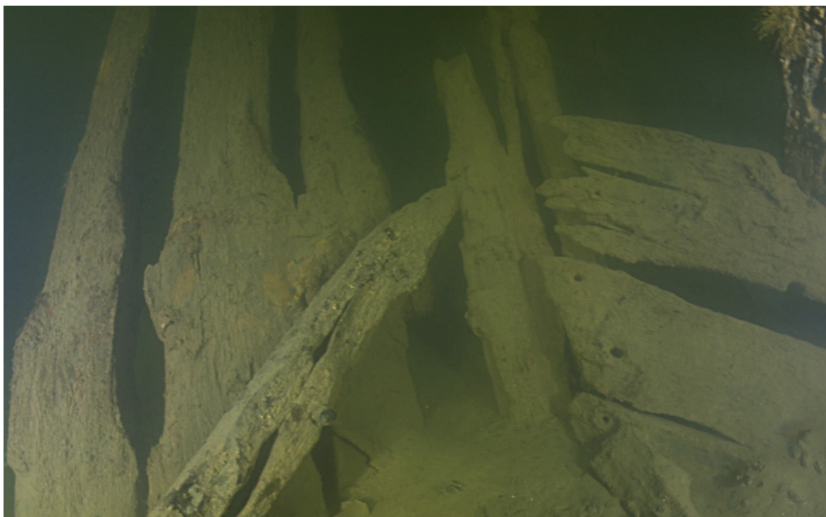
FIGUR 69. Rodrets tre beståndsdelar och akterstäven sett från styrbords sida. Här kan man fortfarande se ett par bordläggningsplankor som når spunningen på akterstäven. Foto: Jim Hansson, SMMTF. (Digitalt museum: VK. V 0472).
