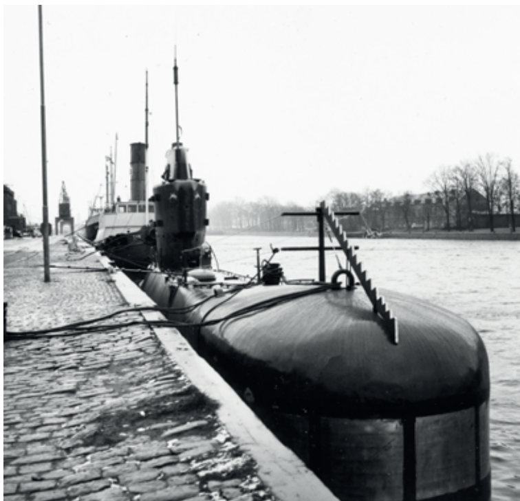
Ubåtsnät var ett försök att stoppa ubåtar från att tränga in i områden som skulle skyddas, exempelvis hamnar. Men som fallet ofta är i militära sammanhang så föder medel motmedel. För att försöka ta sig igenom ubåtsnät så utrustades ubåtar med nätsågar. Ubåten Makrillen med nätsåg i fören i slutet av 1960-talet.
